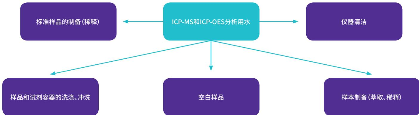
图1. ICP-MS和ICP-OES分析中所使用的不同类型的超纯水
