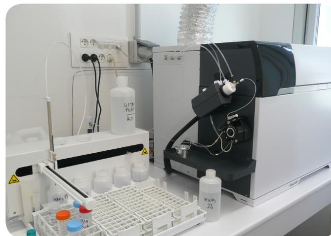
用来分析硼样品的ICP-MS实验室
