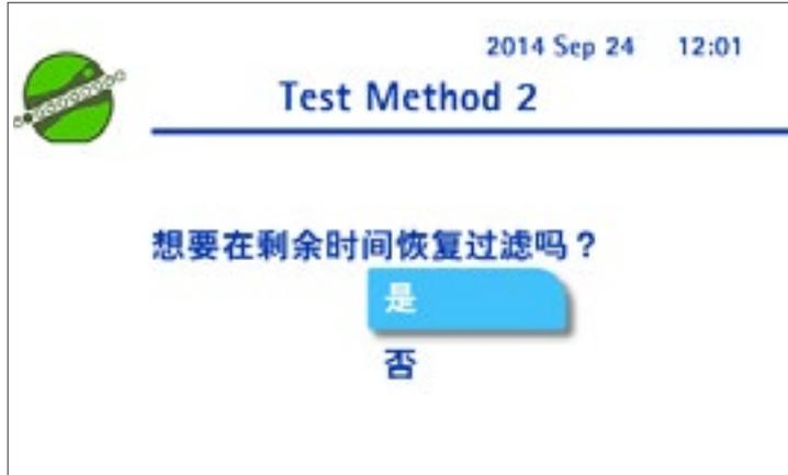
2. 旋转并按下控制钮选择否。按下控制钮，即可在定时器定时结束之前停止泵。
