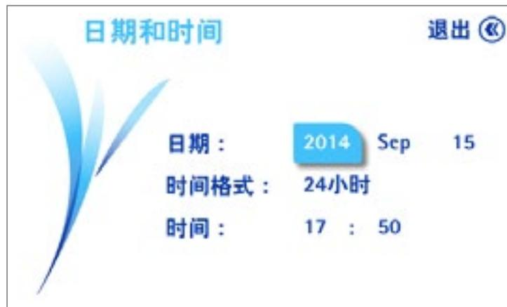
2. 旋转控制钮可以从一个字段移到另一个字段。如要更改某个值， 按下控制钮进入该值的字段， 然后旋转控制钮改变该字段中的值。按控制钮确认所做的更改。
