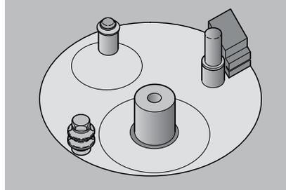
9. 用无纺布蘸取本节所列出的推荐使用的某种清洁剂，擦拭排水盘支架和排水盘容器，然后用干净的水冲洗。
