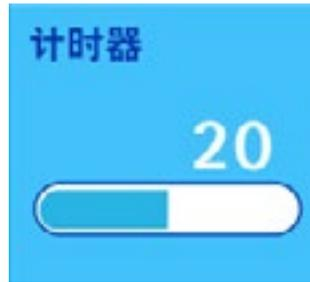
定时器功能在预设的过滤时间之后自动停止泵。定时器值的可调范围为关（未使用）至999（请参见[在标准模式下使用泵](#)。
