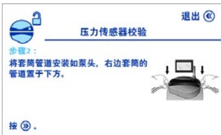
将管子安装到泵中（请参见[使用Steritest™ Symbio泵](#)，[安装Steritest™ EZ装置](#)），右套筒的管子置于下方。
