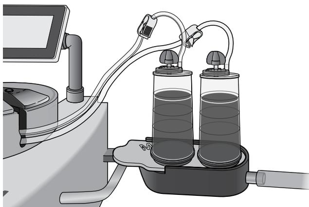
从排水盘中取下套筒，从套筒出口取下黄色的塞子，然后将套筒放回到排水盘中。
