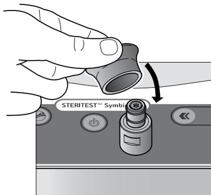
3. 如果已拆下泵头转子，则重新将其安装到位，转子上的槽口要对准对准线。
