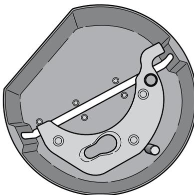
5. 用无纺布蘸取本节所列出的推荐使用的某种清洁剂，擦拭泵头转子的外表面。
