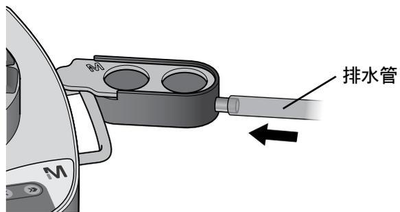
5. 将排水管的另一端直接置于废液容器中（对于LFH式），或者连接到隔离器台的下水道（对ISL式）。
