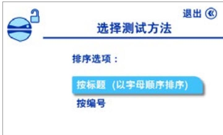
3. 旋转并按下控制钮选择你想要的测试方法排序选项。这时将列出泵中存储的测试方法：
