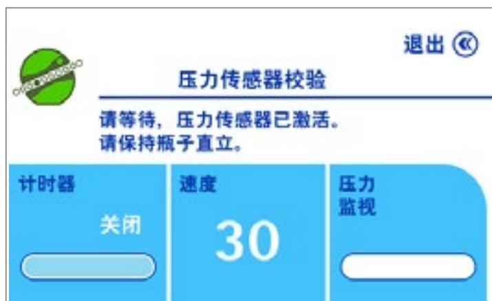
泵头关闭，泵以定速30启动。
