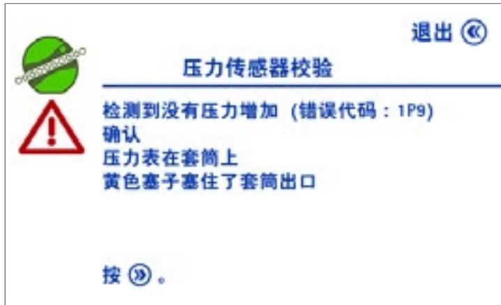
确保压力计牢固地安装在套筒上，且黄色塞子塞在套筒的出口。
