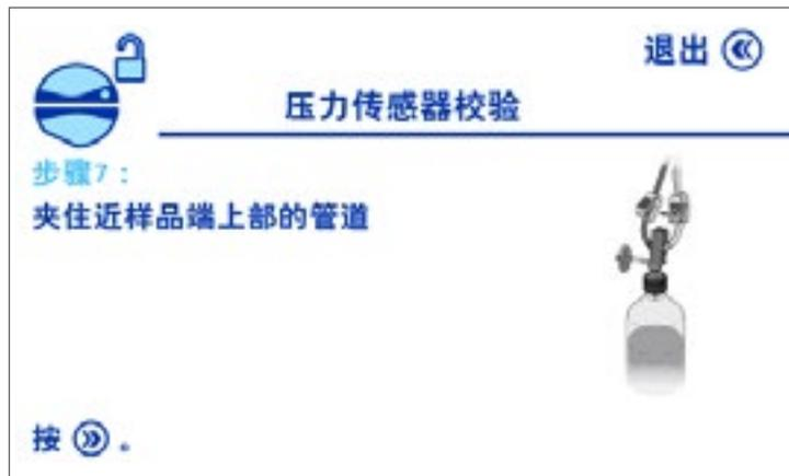
在瓶子一端，夹住管子上部，以防液体传送到未测试的Steritest™ 套筒。
