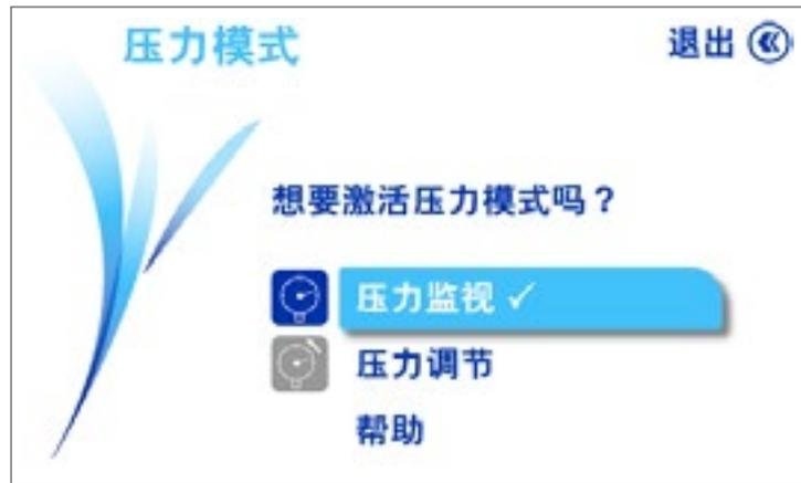
2. 旋转并按下控制钮选择压力模式。✓符号表示被启用的模式。
