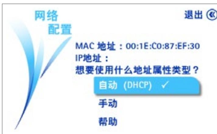
地址属性类型的默认设置是自动（DHCP）。泵的IP地址由DHCP服务器自动分配。不需进行特别操作来配置连接。
