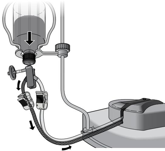
液体被传送到受测套筒中，这时压力计上显示压力升高。
