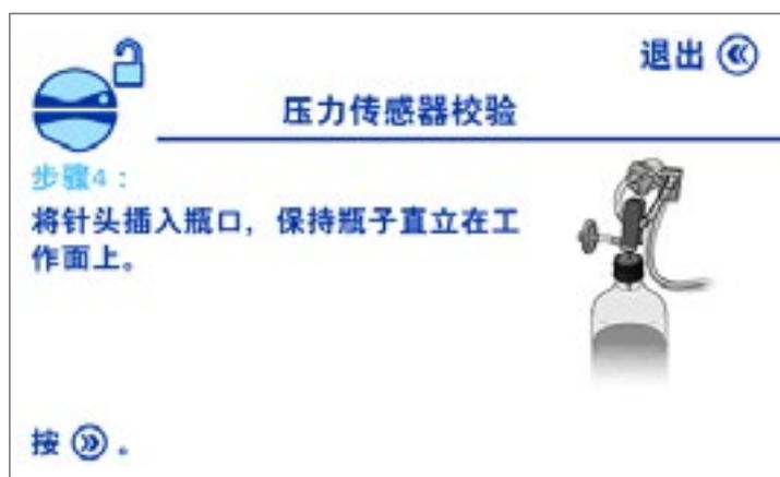
将Steritest™ 针头转接器插入无菌冲洗液瓶中（体积 > 500 ml）。
