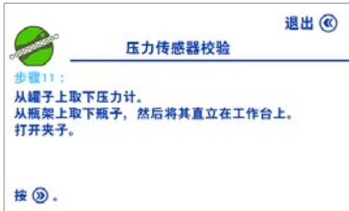
取下Steritest™ 泵的压力测试组件，以释放套筒中的压力。
