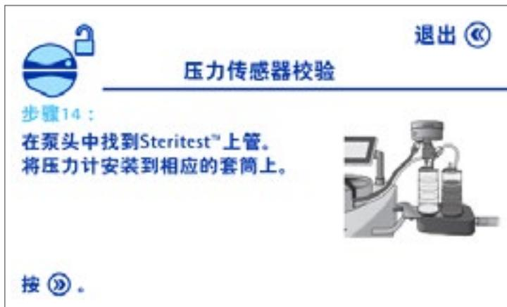
在泵头中找到Steritest™上管。在相应的套筒上安装Steritest™ 泵的压力测试组件。
