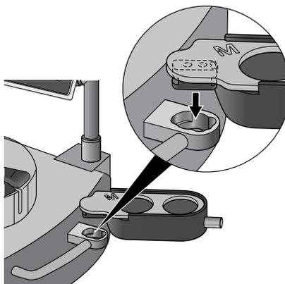
3. 向泵的前方转动排水盘，以将其紧固到卡箍中。
