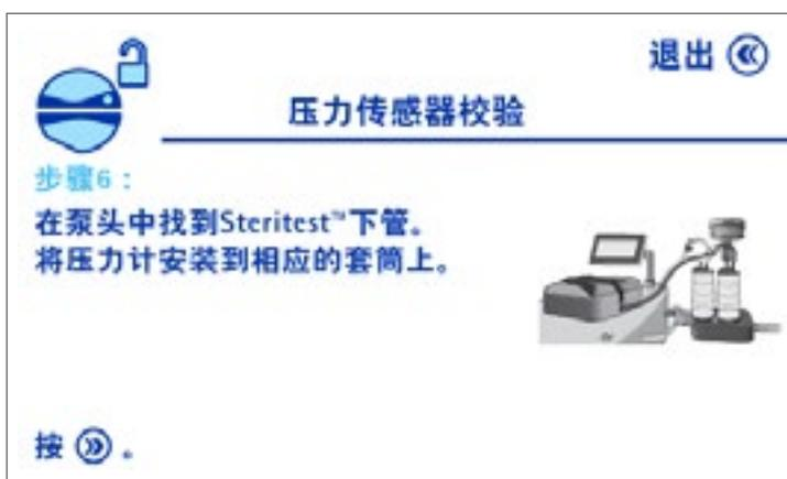
在泵头中找到Steritest™ 下管。在相应的套筒上安装Steritest™ 泵的压力测试组件（请参见[辅件和更换件](#)）。
