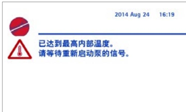
这时不能完成测试。不得对泵进行任何动作，须等到温度回到可接受的水平（现在只有停泵操作是允许的）。当内部温度回到可接受水平时，将显示下列信息，并间歇发出嘟嘟声10秒钟。这时泵可以重新继续测试操作。
