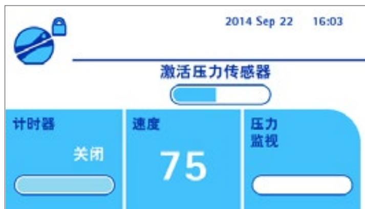
当压力传感器激活后，即可启动泵。
