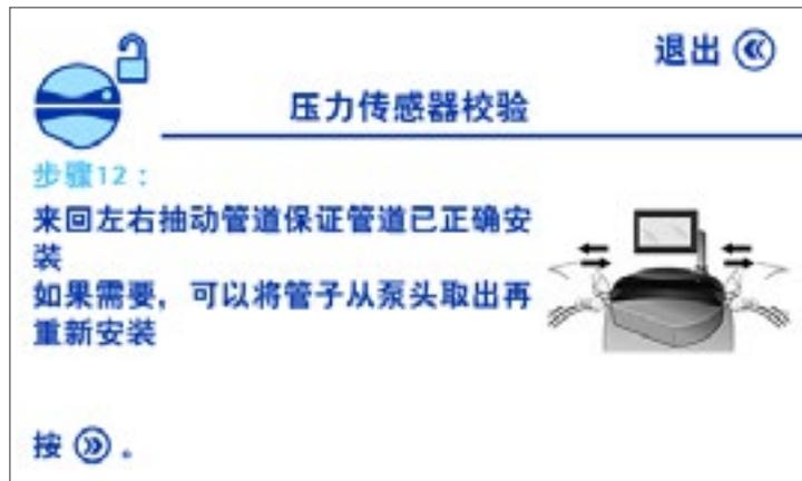
左右抽动管子，使其正确定位。如果管子不能自如滑动，则从泵头中取出管子，然后重新安装管子。
