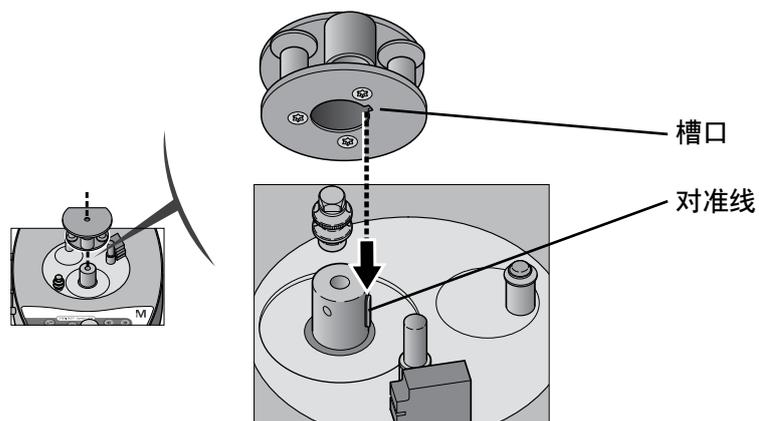
4. 插上泵头转子安装螺钉，然后用4 mm六角扳手拧紧。
