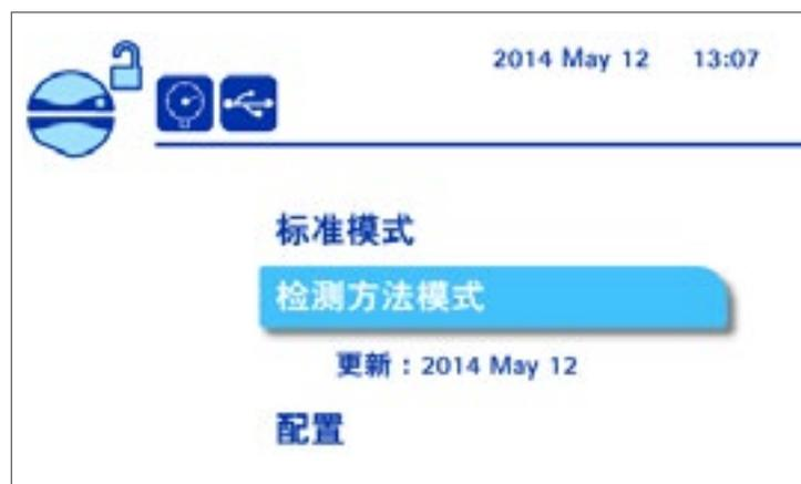
2. 旋转并按下控制钮选择测试方法模式。这时将显示测试方法排序选项画面：
