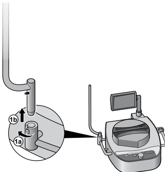
9. 完全拧松和取下螺钉，即可折下瓶座紧固系统：
