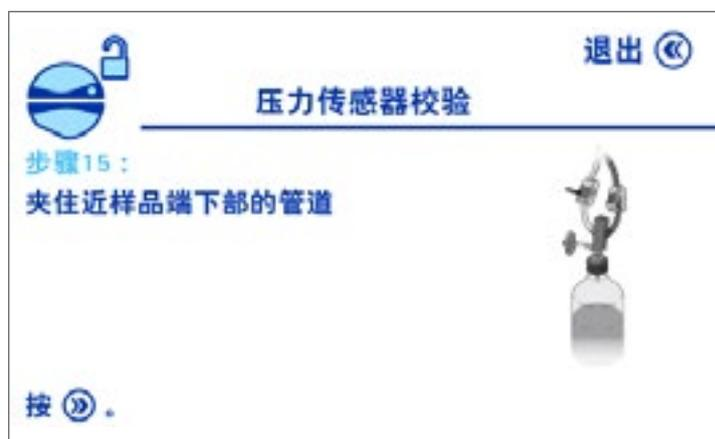
在瓶子一端，夹住管子下部，以防液体从未测试的管子传送到套筒中。
