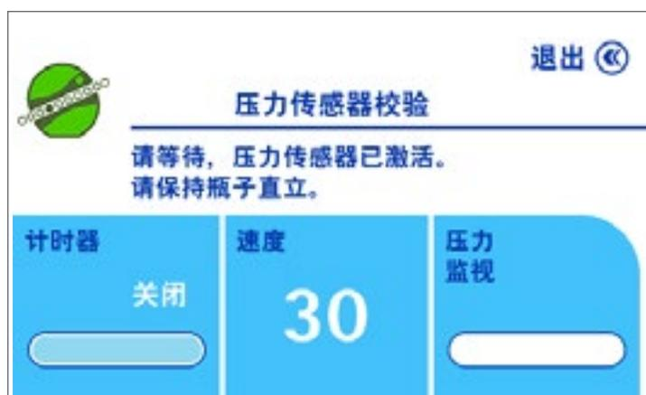
泵头关闭，泵以定速30启动。
