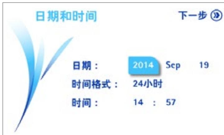
6. 如要设置日期、格式和时间，旋转控制钮可以从一个字段移到另一个字段。如要更改某个值，按下控制钮进入该值的字段，旋转控制钮改变该值，然后再按下控制钮确认所做的更改。
