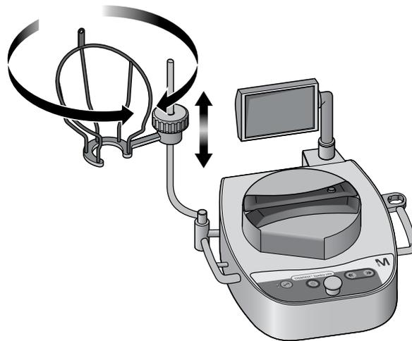
6. 拧紧螺钉，以将瓶架筐紧固到位。
