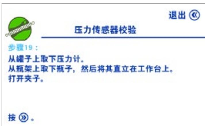
取下Steritest™ 泵的压力控制组件，以释放滤罐中的压力。
