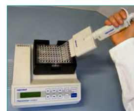
6. Waschen (Entfernen ungebundener Komponenten, 2x 1min)
