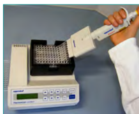
4. Waschen (Entfernen ungebundener Komponenten, 2 min)
