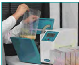
1. Probenaufschluss & Anreicherung, (optional Plattieren)
