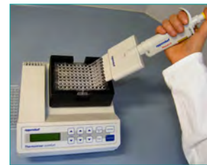
6. Waschen (Entfernen ungebundener Komponenten, 2x 1 min)
