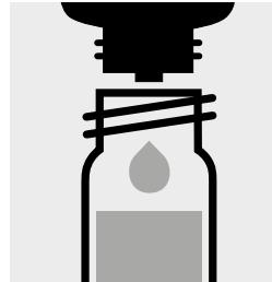
Ajouter 2 gouttes de Ni-2K, fermer avec le bouchon fileté et mélanger.
