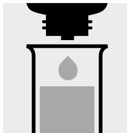
Ajouter 1 goutte de Ni-1 et mélanger. Si la solution se décolore, augmenter la dose de réactif goutte à goutte jusqu'à obtenir une légère coloration jaune constante.
