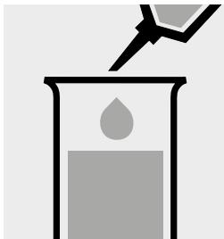
Pipetter 5,0 ml d'échantillon dans une éprouvette.
