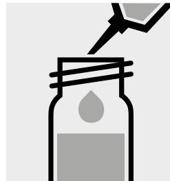
Ajouter 5,0 ml d'eau distillée (nous recommandons l'art. 1.16754, Eau pour analyses EMSURE®) à la pipette, écraser avec la baguette d'agitation et fermer avec le bouchon fileté et mélanger.
