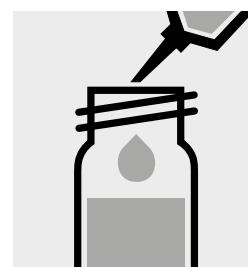
Pipetter 2,0 ml d'eau distillée (nous recommandons l'art. 1.16754, Eau pour analyses EMSURE®) dans un vaisseau (20 ml) qui peut être fermé.
