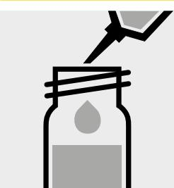
Pipetter 0,100 ml de solution d'échantillon préparé (filtrat) dans un tube avec le bouchon fileté.
