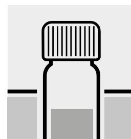
Refroidir le tube conformément à EN 1141 [1] ou l'article 64 de LFGB 31.00-7 [2].
