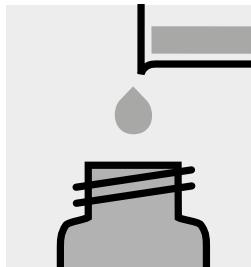
Ajouter env. 30 ml d'éthanol en ébullition et laisser refroidir à la température ambiante.
