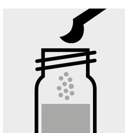
Ajouter 1 microcuiller verte arasée de **CN-3**, fermer avec le bouchon fileté.
