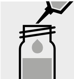
Pipetter 0,50 ml de Na-1K dans un tube à essai et mélanger.
