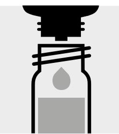
Ajouter 5 gouttes de **P-2K**, fermer avec le bouchon fileté et mélanger.
