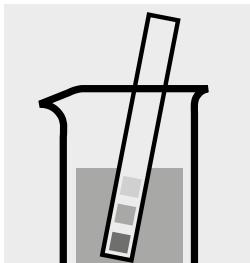
Vérifier le pH de l'échantillon. Domaine nécessaire : pH 3 – 7
