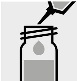
Ajouter 5,0 ml d'**acide sulfurique 40 %**. Fermer avec le bouchon fileté et mélanger.
