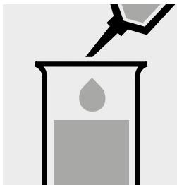
Pipetter 5,0 ml d'échantillon dans une éprouvette.
