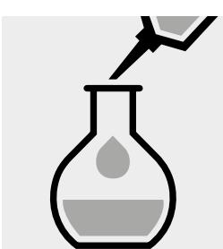
Remplir le ballon gradué jusqu'à la marque avec de **cyclohexane pour la spectroscopie Uvasol®** (art. 1.02822) et mélanger.
