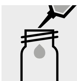
Pipetter 5,0 ml d'**échantillon préparé** dans un tube vide (tubes vides, art. 1.14724).
