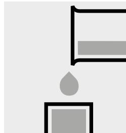
Transvaser l'échantillon de mesure dans la cuve en quartz.
