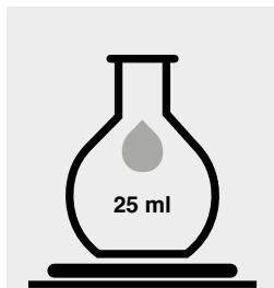
Peser l'échantillon entre 100 mg et 500 mg dans un ballon gradué de 25 ml.
