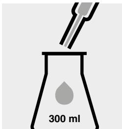
Donner 20 ml d'eau distillée (nous recommandons l'art. 1.15333, Eau pour la chromatographie LiChrosolv®) dans un deuxième erlenmeyer de 300 ml à joint 29/32 à l'aide d'une pipette de verre.
