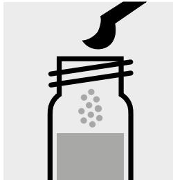
Ajouter 1 microcuiller grise arasée de Ph-1K, fermer avec le bouchon fileté.
