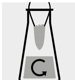
Agiter à la température ambiante pour 2 heures à 250 tours/min : échantillon appauvri / échantillon à blanc appauvri
