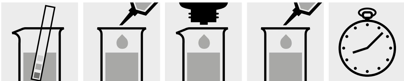
Vérifier le pH de l'échantillon. Domaine nécessaire : pH 2 – 8. Si nécessaire, ajuster le pH en ajoutant goutte à goutte du sodium hydroxyde en solution diluée ou de l'acide nitrique dilué.
