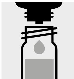
Ajouter 5 gouttes de Zn-1, fermer avec le bouchon fileté et mélanger.
