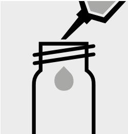
Pipetter 10 ml d'eau distillée (nous recommandons l'art. 1.01262, Eau Ultrapur) dans un deuxième récipient en plastique (**Tubes à fond plat, art. 1.17988**). (Blanc)
