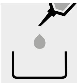
Pipetter 25,0 ml de l'échantillon dans une coupe en platine et effectuer une incinération conformément à EN 1136 [3].
