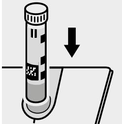
Placer le tube dans le compartiment, faire coïncider le trait du tube sur celui du photomètre.
