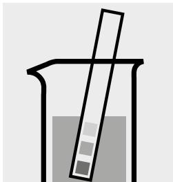
Vérifier le pH de l'échantillon. Domaine nécessaire : pH 1 – 10. Si nécessaire, ajuster le pH en ajoutant goutte à goutte du sodium hydroxyde en solution diluée ou de l'acide chlorhydrique dilué.
