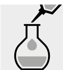
Remplir le ballon gradué jusqu'à la marque avec d'isooctane pour la spectroscopie Uvasol® (art. 1.04718) et mélanger.
