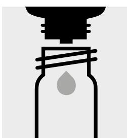
Verser 6 gouttes de Cr-3K dans un tube à essai, fermer avec le bouchon fileté et l'agiter légèrement.
