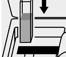
Placer la cuve dans le compartiment. La mesure est effectuée automatiquement.
