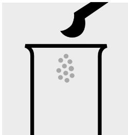
Verser 1 microculler grise arasée de SO<sub>3</sub>-1 dans une éprouvette sèche.
