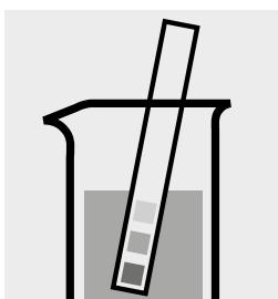
Vérifier le pH de l'échantillon. Domaine nécessaire : pH 5 – 10. Si nécessaire, ajuster le pH en ajoutant goutte à goutte du sodium hydroxyde en solution diluée ou de l'acide sulfurique dilué.
