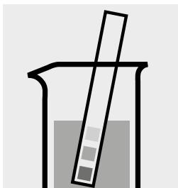
Vérifier le pH de l'échantillon. Domaine nécessaire : pH 2 – 10. Si nécessaire, ajuster le pH en ajoutant goutte à goutte de l'acide sulfurique dilué.
