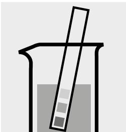
Vérifier le pH de l'échantillon. Domaine nécessaire : pH 0 – 10
