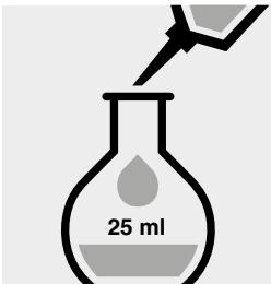
Pipetter 10 ml d'échantillon dans un ballon jaugé de 25 ml.
