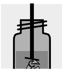
Broyer le filtre à l'aide d'un homogénéisateur
