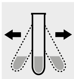
Agiter vigoureusement l'éprouvette pendant **1 minute** pour dissoudre la substance solide.
