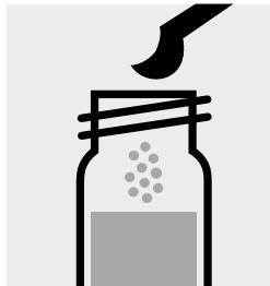
Ajouter 1 microcuiller grise arasée de SO<sub>3</sub>-1K dans chacun de deux tubes à essai, fermer avec le bouchon fileté.
