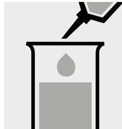
Ajouter 10 ml d'eau distillée (nous recommandons l'art. 1.16754, Eau pour analyses EMSURE®) à la pipette dans la deuxième éprouvette et mélanger. (Blanc)
