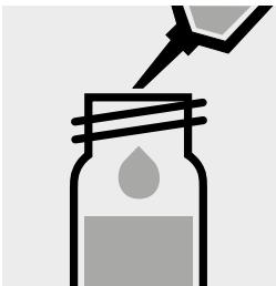
Ajouter 2 ml de **réactif de couleur**, fermer avec le bouchon fileté et mélanger.
