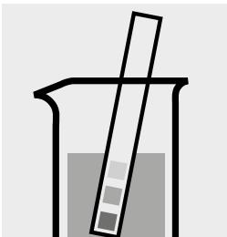
Vérifier le pH de l'échantillon. Domaine nécessaire : pH 3 – 10. Si nécessaire, ajuster le pH en ajoutant goutte à goutte du sodium hydroxyde en solution diluée ou de l'acide sulfurique dilué.
