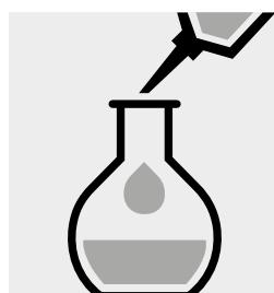
Ajouter 25 ml de réactif de molybdate de sodium/de l'acide ascorbique et mélanger.
