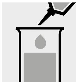
Ajouter 5,0 ml d'eau distillée et 0,50 ml d'échantillon à la pipette et mélanger.
