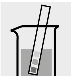
Vérifier le pH de l'échantillon. Domaine nécessaire : pH 2 – 12. Si nécessaire, ajuster le pH en ajoutant goutte à goutte de l'acide sulfurique dilué.
