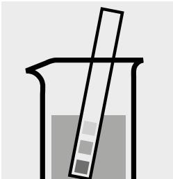
Vérifier le pH de l'échantillon. Domaine nécessaire : pH 6 – 8
