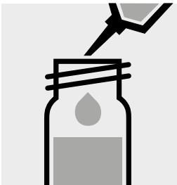
Pipetter 0,20 ml d'échantillon dans un tube à essai, fermer avec le bouchon fileté et mélanger.
