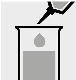
Pipetter 5,0 ml d'eau distillée (nous recommandons l'art. 1.16754, Eau pour analyses EMSURE®) dans une éprouvette.
