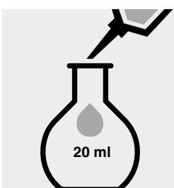
Introduire 10 ml de réactif de molybdate de sodium/de l'acide ascorbique dans un ballon jaugé de 20 ml.
