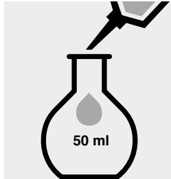
Introduire 20 ml d'**acide sulfurique 0,05 mol/l** dans un ballon jaugé de 50 ml.
