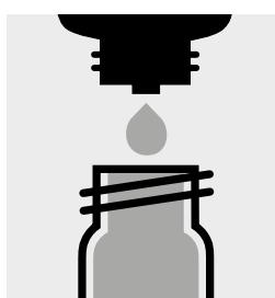
Ajouter 10 gouttes de O<sub>2</sub>-3K, fermer le tube, mélanger et essuyer l'extérieur.
