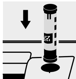
Sélectionner la méthode 5 – 500 mg/l de Si avec l'AutoSelector.
