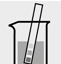
Vérifier le pH de l'échantillon. Domaine nécessaire : pH 2 – 12
