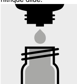
Ajouter 5 gouttes de O<sub>2</sub>-2K, fermer avec le bouchon fileté et agiter pendant 10 secondes.
