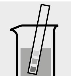
Vérifier le pH de l'échantillon. Domaine nécessaire : pH 6 – 8. Si nécessaire, ajuster le pH en ajoutant goutte à goutte du sodium hydroxyde en solution diluée ou de l'acide sulfurique dilué.
