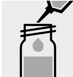
Pipetter 2,0 ml d'échantillon dans un tube à essai, fermer avec le bouchon fileté et mélanger.
