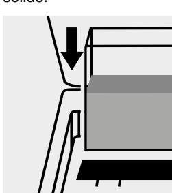
Placer la cuve de l'échantillon dans le compartiment.
