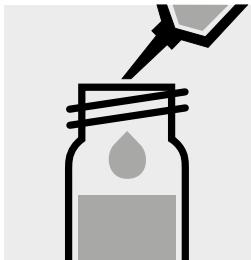
Pipetter 0,10 ml d'échantillon dans un tube à essai, fermer avec le bouchon fileté et mélanger.
