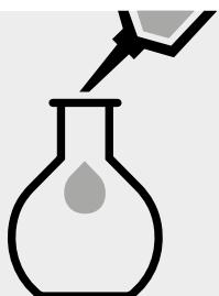
Si nécessaire, diluer l'échantillon avec de l'eau distillée jusqu'au trait de jauge (nous recommandons l'art. 1.16754, Eau pour analyses EMSURE®).
