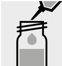
Ajouter 2,0 ml de **réactif DNSA** à la pipette, fermer et mélanger.
