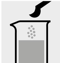
Ajouter 1 microcuiller grise arasée de Zn-1K et dissoudre la substance solide : **mélange échantillon - réactif**.
