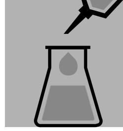
Aciduler une partie de l'extrait avec de l'**acide chlorhydrique 1 mol/l Titripur®** (art. 1.09057) (50 µl par 5 ml d'extrait).
