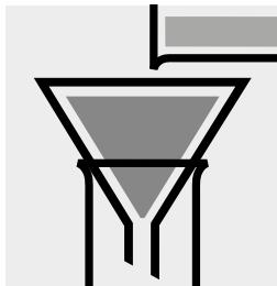
En cas de contamination filtrer l'échantillon par un papier filtrant rapide.
