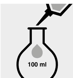
Introduire 50 ml d'eau distillée jusqu'au trait de jauge (nous recommandons l'art. 1.16754, Eau pour analyses EMSURE®) dans un ballon jaugé de 100 ml.
