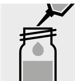
Ajouter 10 ml de **n-butyle acétate** et fermer avec le bouchon fileté.
