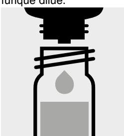
Ajouter 5 gouttes de **Zn-3K**, fermer avec le bouchon fileté et mélanger.
