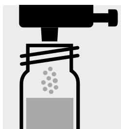
Ajouter 1 dose de Fe-1K avec le capuchon doseur bleu, fermer avec le bouchon fileté.
