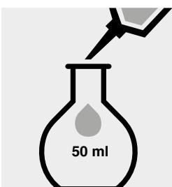
Introduire 1 ml d'échantillon préparée dans un ballon jaugé de 50 ml.
