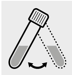
Agiter le tube avant la mesure.
