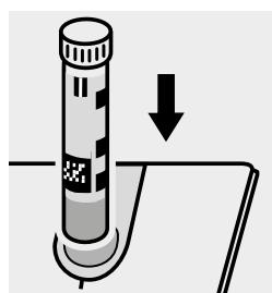
Placer **sans agitant à nouveau** le tube dans le compartiment, faire coïncider le trait du tube sur celui du photomètre.
