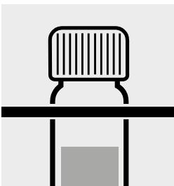
Replacer le tube dans le support et laisser refroidir jusqu'à température ambiante (**très important**).
