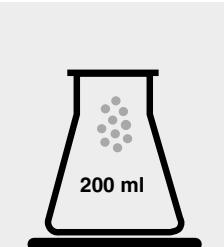
Peser 10 g d'échantillon préparé avec une exactitude de 1 mg dans un erlenmeyer et effectuer une extraction conformément à EN ISO 11052 [1] ou l'article 64 de LFGB 16.01-3 [2] : échantillon de mesure.
