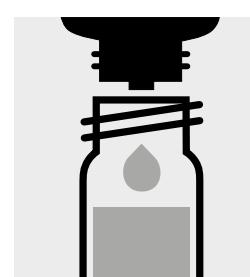
Ajouter 5 gouttes **AOX-4**, boucher avec le bouchon fileté et mélanger. Faire décanter le charbon actif. solution surnageante : échantillon préparé
