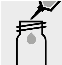
Pipetter 5,0 ml de l'échantillon dilué à 1:500 dans un tube vide (tubes vides, art. 1.14724).
