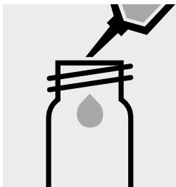
Pipetter 4,0 ml de NO<sub>3</sub>-1 dans un tube vide (tubes vides, art. 1.14724) et sèche.
