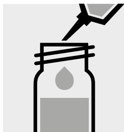
Ajouter 5 ml de **réactif d'oxydation** et mélanger.
