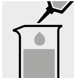
Ajouter 1 ml de l'**acide chlorhydrique 1 mol/l Titripur®** (art. 1.09057) à la pipette et mélanger.
