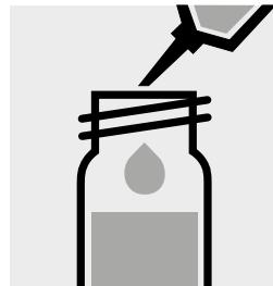
Ajouter 2,0 ml de **mélange échantillon - réactif** à la pipette, fermer avec le bouchon fileté et mélanger.
