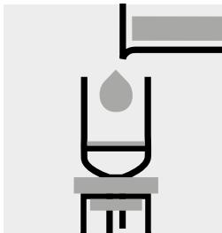
Filtrer l'échantillon par un filtre adéquat (p. ex. à fibres de verre).
