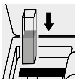
Placer la cuve dans le compartiment. La mesure de la valeur à blanc est effectuée automatiquement.
