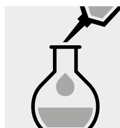
Ajouter 2 ml de **réactif d'heptamolybdate d'ammonium**.
