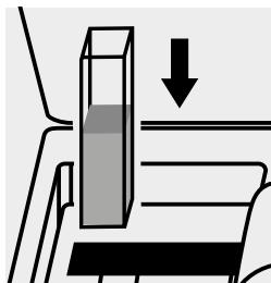
Placer la cuve dans le compartiment. La mesure est effectuée automatiquement.
