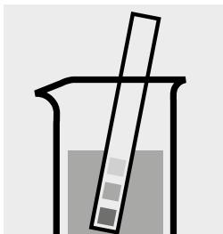
Vérifier le pH de l'échantillon. Domaine nécessaire : pH 1 – 10
