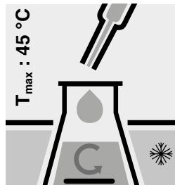
Ajouter dans chacun des deux erlenmeyers **lentement** 25 ml d'acide sulfurique pour le dosage de DCO (art. 1.17048) à la pipette de verre **en agitant et en refroidissant**.
