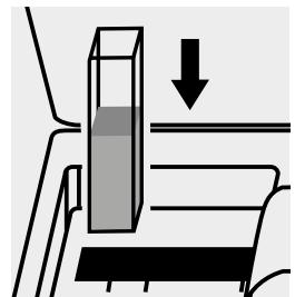
Placer la cuve dans le compartiment. La mesure est effectuée automatiquement.
