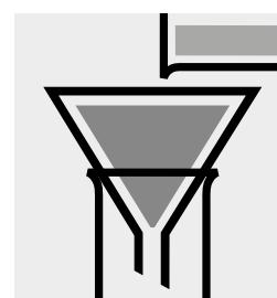
Filtrer tout le mélange à travers un filtre hydrophobe conformément à EN 1141 [1] ou l'article 64 de LFGB 31.00-7 [2] : **blanc réactif**.
