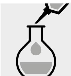
Remplir le ballon gradué jusqu'à la marque avec **d'isoctane pour la spectroscopie Uvasol®** (art. 1.04718) ou de **cyclohexane pour la spectroscopie Uvasol®** (art. 1.02822) et mélanger.
