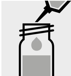
Ajouter à la pipette 0,10 ml d'échantillon, fermer avec le bouchon fileté et mélanger. **Attention, le tube devient brûlant.**
