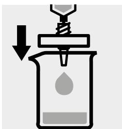
Filtrer 10 - 20 ml de la solution préparée par un filtre à membrane dans un bêcher propre et sec.
