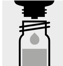
Ajouter 6 gouttes de K-1K, fermer avec le bouchon fileté et mélanger.
