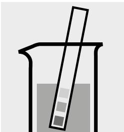
Vérifier le pH de l'échantillon. Domaine nécessaire : pH 5 – 8
