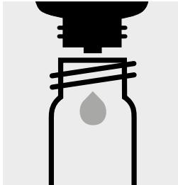
Verser 6 gouttes de Cr-3K dans un tube à essai, fermer avec le bouchon fileté et **l'agiter légèrement**.
