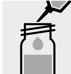
Ajouter 0,50 ml de **Sn-1K** à la pipette, fermer avec le bouchon fileté et mélanger.
