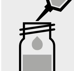
Ajouter 0,10 ml de **Si-2** à la pipette dans chacun de deux récipients, fermer avec le bouchon fileté et mélanger.
