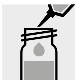
Ajouter 5,0 ml de Zn-6 (art. 1.06146, isobutylméthylcétone) à la pipette et fermer avec le bouchon fileté.
