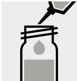
Pipetter 4,0 ml d'échantillon dans un tube à essai, fermer avec le bouchon fileté et mélanger.
