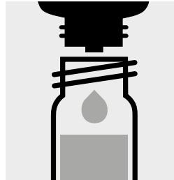
Ajouter 2 gouttes de Ni-1K, fermer avec le bouchon fileté et mélanger.
