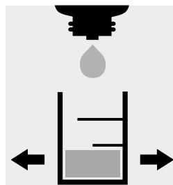
Vérifier la teneur de chlorure de échantillon appauvri à l'aide du test chlorures MQuant® (art. 1.11132) conformément aux consignes d'application (cf. site web) : Consigne <250 mg/l de Cl<sup>-</sup>
