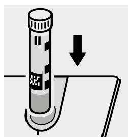
Placer **sans agitant à nouveau** le tube dans le compartiment, faire coïncider le trait du tube sur celui du photomètre.
