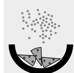
Mélanger avec le sable marin et effectuer une extraction conformément à l'article 64 de LFGB 03.00.37, chapitre 9.1.1 [1] : **extrait d'échantillon.**
