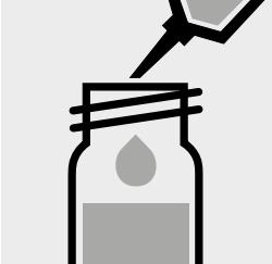
Ajouter 0,50 ml de **Si-3** à la pipette dans chacun de deux récipients, fermer avec le bouchon fileté et mélanger.
