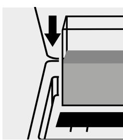
Placer la cuve dans le compartiment. La mesure est effectuée automatiquement.
