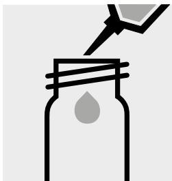
Pipetter 10 ml d'échantillon dans un tube vide (tubes vides, art. 1.14724).
