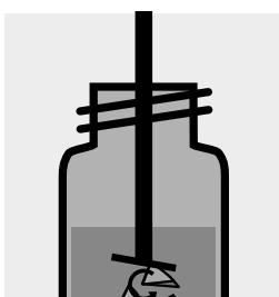
Broyer le filtre à l'aide d'un homogénéisateur
