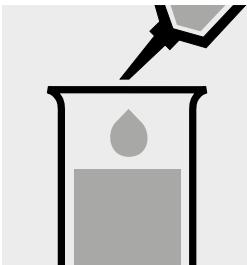
Pipetter 5,0 ml d'échantillon dans une éprouvette.
