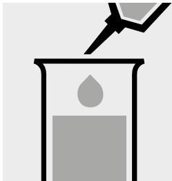
Pipetter 0,20 ml de Cl-1 dans chacun de deux éprouvettes.
