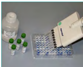
7. Farbreaktion (Farbreaktion und Abstoppen, 2-15 min)
