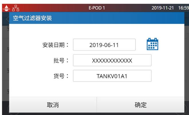
您可以手动键入，亦可通过扫描位于E-POD®取水单元手柄上的e-Sure标签读取器上的RFID卡来注册数据。如果您手动输入数据，请将“XXXXXXXXXXXX”替换为空气过滤器的实际批号。您可以在盒子的标签上找到批号。
