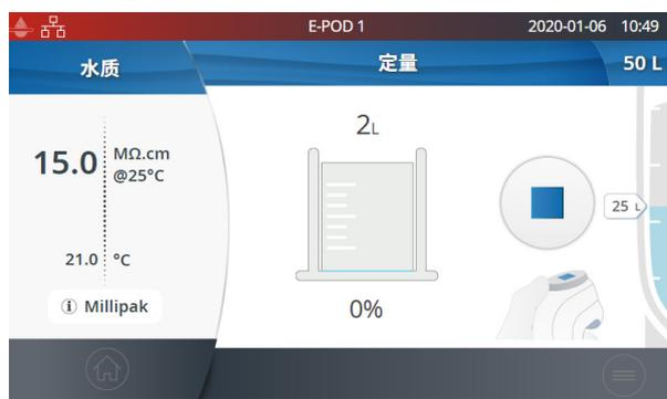
5- 当取用了输入的体积时,系统将自动停止取水。按下屏幕上的“停止”按钮或取水手轮,或踩下脚踏板,即可停止取水。
