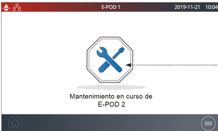
Mantenimiento en curso de otra unidad E-POD® o de una ubicación remota si en la pantalla se indica "Externo".
