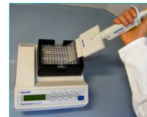
6. Waschen (Entfernen ungebundener Komponenten, 2x 1min)
