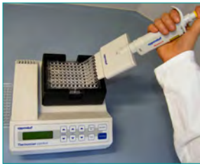
4. Waschen (Entfernen ungebundener Komponenten, 2 min)
