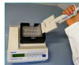
6. Waschen (Entfernen ungebundener Komponenten, 2x 1min)
