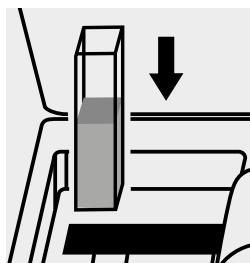
Inserire la cuvetta nell'alloggiamento cuvette.
