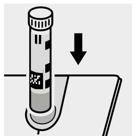
Inserire la cuvetta nell'alloggiamento. Far coincidere la tacca della cuvetta con l'indicatore del fotometro.
