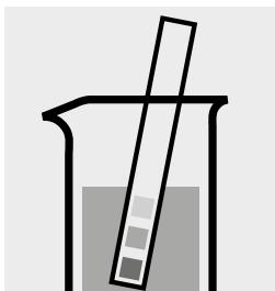
Controllare il pH del campione. Intervallo necessario: pH 3–12
