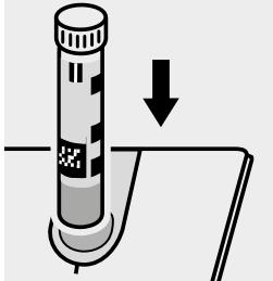
Inserire la cuvetta nell'alloggiamento cuvette.
