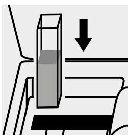
Inserire la cuvetta nell'alloggiamento cuvette.
