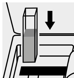
Inserire la cuvetta nell'alloggiamento cuvette.
