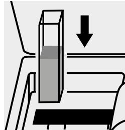
Inserire la cuvetta nell'alloggiamento cuvette.
