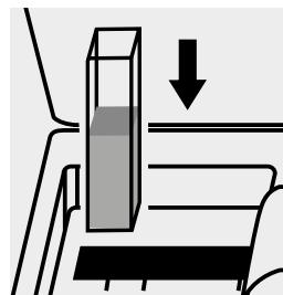
Inserire la cuvetta nell'alloggiamento cuvette.
