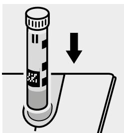
Inserire la cuvetta nell'alloggiamento cuvette. Far coincidere la tacca della cuvetta con l'indicatore del fotometro.
