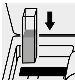
Inserire la cuvetta nell'alloggiamento cuvette.
