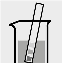
Controllare il pH del campione. Intervallo necessario: pH 2–12
