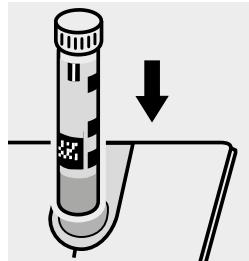
Inserire la cuvetta nell'alloggiamento cuvette.
