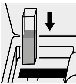
Inserire la cuvetta nell'alloggiamento cuvette.
