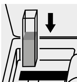
Inserire la cuvetta nell'alloggiamento cuvette.
