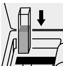
Inserire la cuvetta nell'alloggiamento cuvette.
