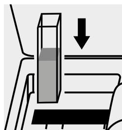
Inserire la cuvetta nell'alloggiamento cuvette.
