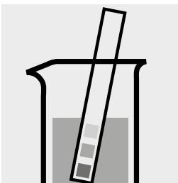
Controllare il pH del campione. Intervallo necessario: pH 0–10
