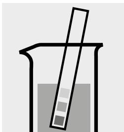
Controllare il pH del campione. Intervallo necessario: pH 4–10
