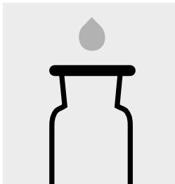
Riempire fino al limite del traboccamiento 2 flaconi di reazione ossigeno con il **campione preparato** e con 2 perle di vetro. Chiudere i flaconi con i rispettivi tappi di vetro obliqui evitando la formazione di bolle d'aria.
