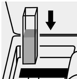
Inserire la cuvetta nell'alloggiamento cuvette.
