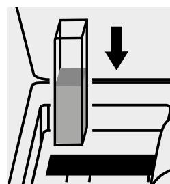
Inserire la cuvetta nell'alloggiamento cuvette.
