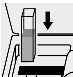
Inserire la cuvetta nell'alloggiamento cuvette.
