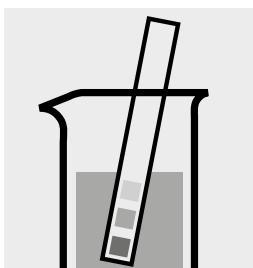
Controllare il pH del campione. Intervallo necessario: pH 4–8
