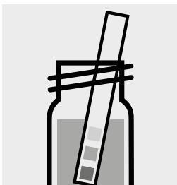
Controllare il pH del campione. Risultato necessario: pH 3,0
