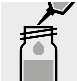
Pipettare 10 ml di acqua distillata in una seconda cuvetta di reazione, chiudere con tappo a vite e mescolare.
