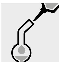
Pipettare 5,0 ml di **As-5** nel tubo di assorbimento.
