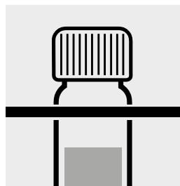
Rimettere la cuvetta sul portaprovette e lasciarla raffreddare completamente a temperatura ambiente (**molti importanti!**).
