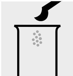
Mettere 1 microcucchiaiino raso grigio di SO<sub>3</sub>-1 in una provetta asciutta.
