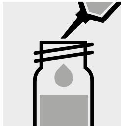
Lentamente pipettare 3,0 ml di **bianco impoverito** in una seconda cuveta di reazione. Chiudere bene e mescolare con forza. **Attenzione: la cuvetta diventa calda!**
