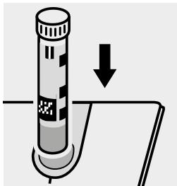
Inserire la cuvetta nell'alloggiamento cuvette.
