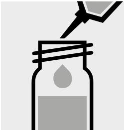
Pipettare 0,50 ml di Na-1K in una cuvetta di reazione e mescolare.
