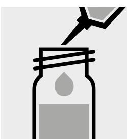
Pipettare 0,100 ml di soluzione campione preparata (filtrato) in una provetta con tappo a vite.
