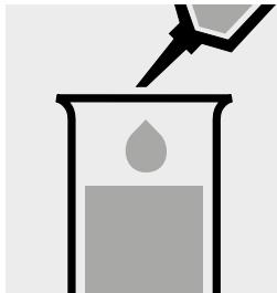
Pipettare 0,50 ml di SO<sub>4</sub>-1 in una provetta.
