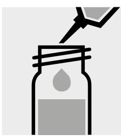
Aggiungere 5,0 ml di Zn-6 (art. 1.06146, isobutilmetilchetone) con pipetta e chiudere bene la provetta con tappo a vite.
