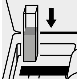
Inserire la cuvetta nell'alloggiamento cuvette.
