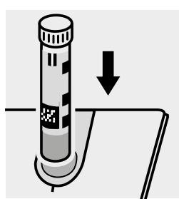
Inserire la cuvetta nell'alloggiamento cuvette.
