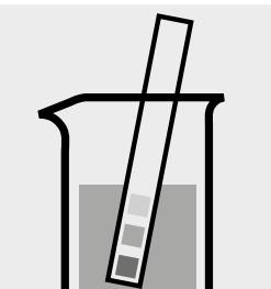
Controllare il pH del campione. Intervallo necessario: pH 3–9
