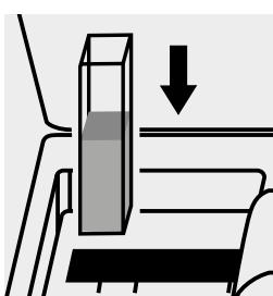
Inserire la cuvetta nell'alloggiamento cuvette.
