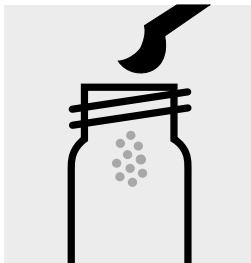
Mettere 1 microcucchiaino raso di **NO<sub>3</sub>-1** in una cuvetta rotonda vuota ed asciutta (cuvette vuote, art. 1.14724).
