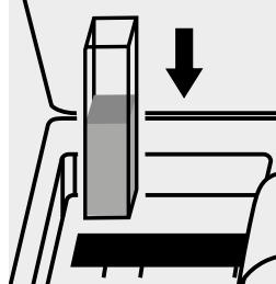
Inserire la cuvetta nell'alloggiamento cuvette.
