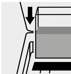
Inserire la cuvetta nell'alloggiamento cuvette.
