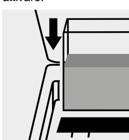
Inserire la cuvetta del campione nell'alloggiamento cuvette.
