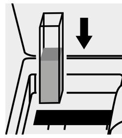
Inserire la cuvetta nell'alloggiamento cuvette.
