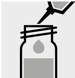
Aggiungere 1,0 ml di N-3K con pipetta, chiudere la cuvetta con tappo a vite e mescolare.
