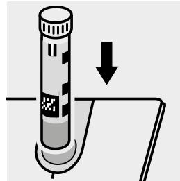
Inserire la cuvetta nell'alloggiamento cuvette.
