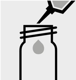
Pipettare 1,0 ml di campione in una cuvetta rotonda vuota (cuvette vuote, art. 1.14724).
