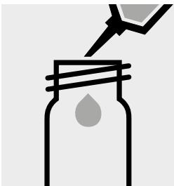
Pipettare 2,0 ml di campione in una cuvetta di reazione, **non mescolare**.
