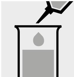
Pipettare 0,50 ml di Pb-1 in una provetta.
