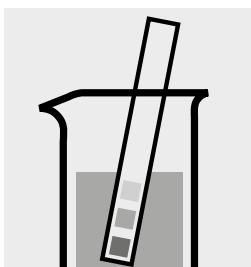
Controllare il pH del campione. Intervallo necessario: pH 3–8
