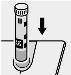
Inserire la cuvetta nell'alloggiamento cuvette.
