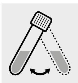
Agitare lentamente la cuvetta per sciogliere la sostanza solida.
