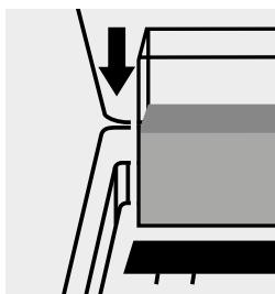
Inserire la cuvetta nell'alloggiamento cuvette.
