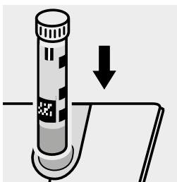
Inserire la cuvetta nell'alloggiamento cuvette.
