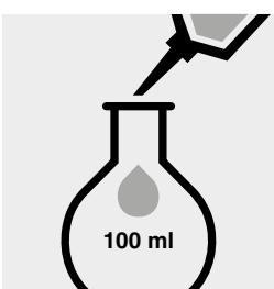
Pipettare, con l'approssimazione di 0,1 ml, il volume appropriato della soluzione campione preparata in un matraccio da 100 ml.
