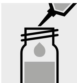
Aggiungere 5,0 ml di **toluene p. a.** (art. 1.08325) con pipetta, chiudere la cuvetta con tappo a vite.
