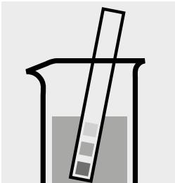
Controllare il pH del campione. Intervallo necessario: pH 1,5 – 2,2
