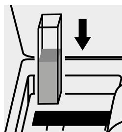
Inserire la cuvetta nell'alloggiamento cuvette.
