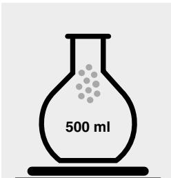
Pesare, con l'approssimazione di 0,1 mg, il campione polverizzato in un matraccio da 500 ml.
