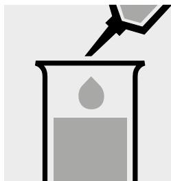
Aggiungere 0,60 ml di NH<sub>4</sub>-1 (da il test Ammonio Spectroquant®, art. 1.14752) con pipetta e mescolare.
