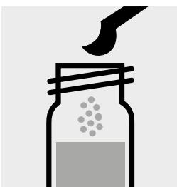
Aggiungere 1 microcucchiaino raso di N-3K nella cuvetta di reazione, chiudere la cuvetta con tappo a vite.
