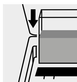
Inserire la cuvetta nell'alloggiamento cuvette.
