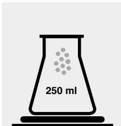
Pesare  $50,0 \pm 0,1$  g di campione omogeneizzato in un matraccio di Erlenmeyer da 250 ml.
