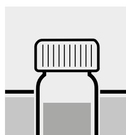
Termostatare il recipiente in un bagno d'acqua a  $95 \pm 5$  °C per **essattamente** 5 minuti.
