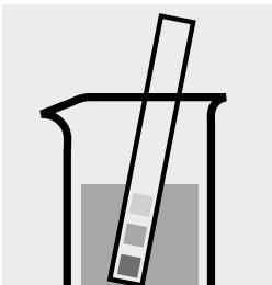
Controllare il pH del campione. Intervallo necessario: pH 3–11
