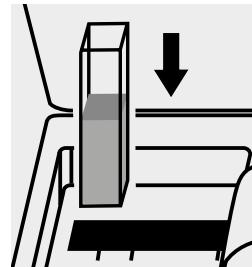
Inserire la cuvetta nell'alloggiamento cuvette.
