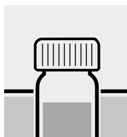
Termostatare il recipiente in un bagno d'acqua a  $95 \pm 5$  °C per **essattamente** 5 minuti.
