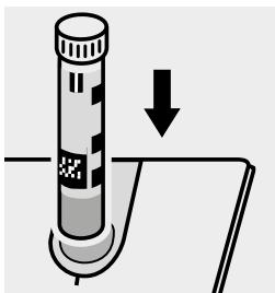
Inserire la cuvetta nell'alloggiamento cuvette.
