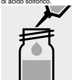
Aggiungere 5,0 ml di **alcol isoamilico p. a.** (art. 1.00979) con pipetta, chiudere la cuvetta con tappo a vite.
