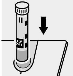
Inserire la cuvetta nell'alloggiamento cuvette.
