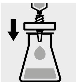
Filtrare la soluzione campione su filtro a membrana con dimensione dei pori di 0,45 µm.
