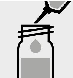
Aggiungere 7,0 ml di campione con pipetta in una cuvetta di reazione, chiudere con tappo a vite e mescolare.
