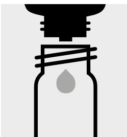
Versare 6 gocce di **Cl<sub>2</sub>-1** in una cuvetta rotonda.
