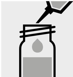
Lentamente pipettare 5,0 ml di **campione impoverito** in una cuveta di reazione. Chiudere bene e mescolare con forza.
