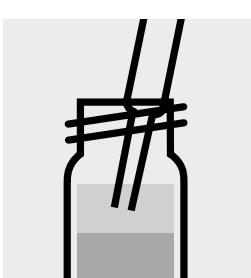
Prelevare lo strato superiore limpido usando una pipetta e farlo essiccare con **solfato di sodio anidro p. a.** (art. 1.06649).
