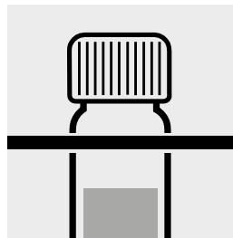
Rimettere la cuvetta sul portaprovette e lasciarla raffreddare completamente a temperatura ambiente (**molto importante!**).
