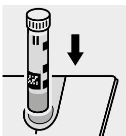
Inserire la cuvetta nell'alloggiamento cuvette. Far coincidere la tacca della cuvetta con l'indicatore del fotometro.
