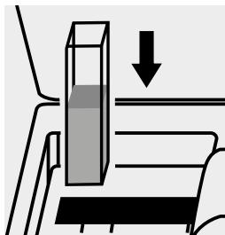
Inserire la cuvetta nell'alloggiamento cuvette.
