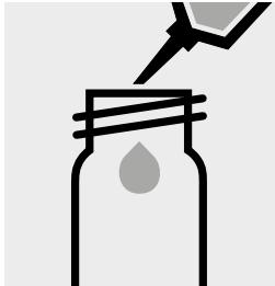
Pipettare 5,0 ml di campione in una cuvetta di reazione, chiudere con tappo a vite e sciogliere la sostanza solida.
