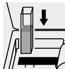
Inserire la cuvetta nell'alloggiamento cuvette.
