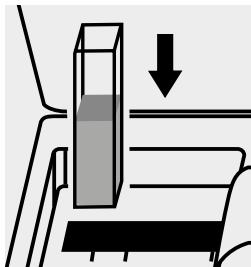
Inserire la cuvetta nell'alloggiamento cuvette.
