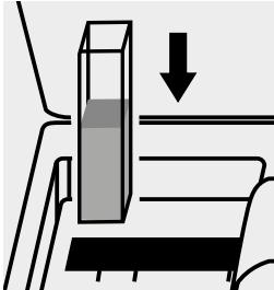
Inserire la cuvetta nell'alloggiamento cuvette.
