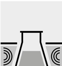
Se il campione contiene aria o gas bolle: degassare in un bagno ad ultrasuoni.
