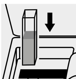
Inserire la cuvetta nell'alloggiamento cuvette.
