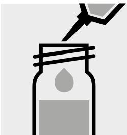
Lentamente pipettare 2,0 ml di campione nella cuvetta di reazione. Chiudere bene e mescolare con forza. **Attenzione:** la cuvetta diventa calda!
