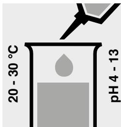
Pipettare 5,0 ml di campione in una provetta. Se necessario correggere il pH aggiungendo goccia a goccia una soluzione diluita di idrossido di sodio o di acido solforico oppure termostatare il campione.
