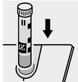
Inserire la cuvetta nell'alloggiamento cuvette.
