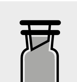
Per la misurazione della concentrazione iniziale di ossigeno, utilizzare rispettivamente un flacone contenente il **campione preparato** ed un flacone contenente la **soluzione di sali nutritivi inoculata** muniti di tappo per 5 giorni a 20 ± 1°C in un incubatore.
