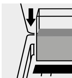
Inserire la cuvetta nell'alloggiamento cuvette.
