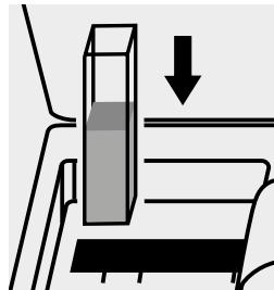
Inserire la cuvetta nell'alloggiamento cuvette.
