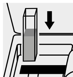
Inserire la cuvetta nell'alloggiamento cuvette.
