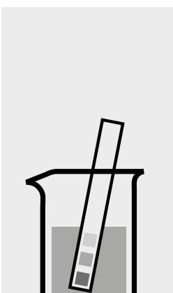
Controllare il pH del campione. Intervallo necessario: pH 6–7. Se necessario correggere il pH aggiungendo goccia a goccia una soluzione diluita di idrossido di sodio o di acido nitrico.
