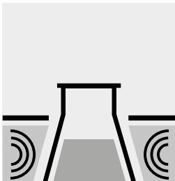
Degassare per 3 minuti in un bagno ad ultrasuoni.
