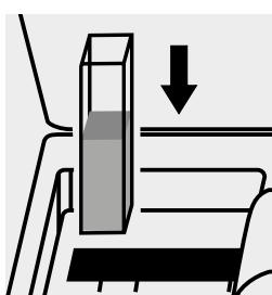
Inserire la cuvetta nell'alloggiamento cuvette.
