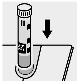
Inserire la cuveta dell bianco nell'alloggiamento cuvette. Far coincidere la tacca della cuvetta con l'indicatore del fotometro.
