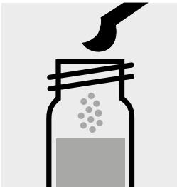
Mettere 1 micro-cucchiaiino raso grigia di SO<sub>3</sub>-1K in una cuvetta di reazione e chiudere con tappo a vite.
