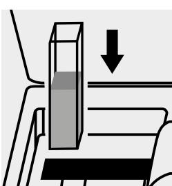
Inserire la cuvetta nell'alloggiamento cuvette.
