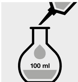
Pipettare 25 ml di campione in un matracchio graduato da 100 ml, portare a volume con acqua distillata e mescolare bene.
