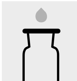
Riempire fino al limite del traboccamento 2 flaconi di reazione ossigeno con la **soluzione di sali nutritivi inoculata** e con 2 perle di vetro. Chiudere i flaconi con i rispettivi tappi di vetro obliqui evitando la formazione di bolle d'aria.
