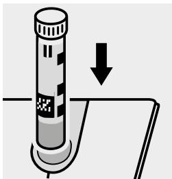
Inserire la cuvetta nell'alloggiamento cuvette.
