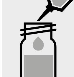
Aggiungere 5,0 ml di **isobutilmethylcheton p. a.** (art. 1.06146) con pipetta, chiudere la cuvetta con tappo a vite.
