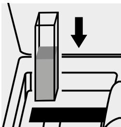
Inserire la cuvetta nell'alloggiamento cuvette.
