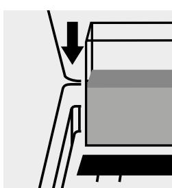
Inserire la cuvetta del campione nell'alloggiamento cuvette.
