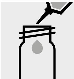
Pipettare 5,0 ml del campione diluito 1:4 in una cuvetta rotonda vuota (cuvette vuote, art. 1.14724).
