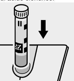
Inserire la cuvetta nell'alloggiamento cuvette.
