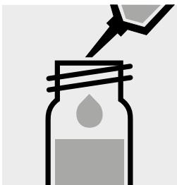
Aggiungere 1,0 ml di **reattivo 1** con pipetta. Chiudere la cuvetta con tappo a vite e mescolare.
