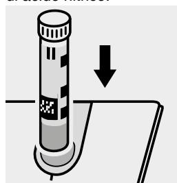
Inserire la cuvetta nell'alloggiamento cuvette.
