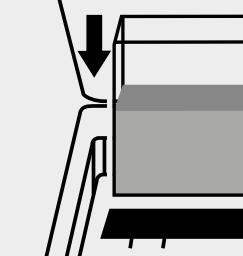
Inserire la cuvetta del bianco nell'alloggiamento cuvette.
