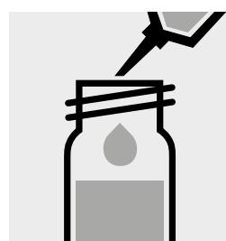
Pipettare 2,0 ml di acqua distillata (si consiglia Acqua per analisi EMSURE®, art. 1.16754) in un recipiente sigillabile (20 ml).
