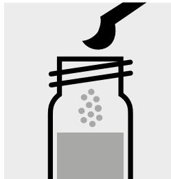
Mettere 1 microcucchiaino raso grigia di SO<sub>3</sub>-1K in ciascuna delle due cuvette di reazione e chiudere con tappo a vite.
