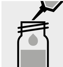
Lentamente pipettare 5,0 ml di **bianco impoverito** in una seconda cuveta di reazione. Chiudere bene e mescolare con forza. **Attenzione: la cuvetta diventa calda!**
