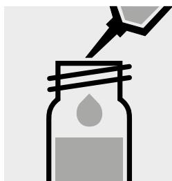
Aggiungere 1,5 ml di **campione preparato** molto lentamente, chiudere la cuvetta con tappo a vite e mescolare brevemente.
