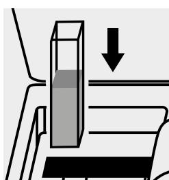
Inserire la cuvetta nell'alloggiamento cuvette.
