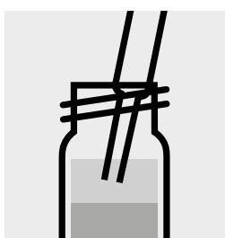
Prelevare lo strato superiore limpido usando una pipetta.
