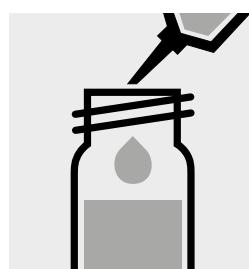
Aggiungere 2,0 ml di **acido cloridrico 6 mol/l** con pipetta, chiudere e mescolare.
