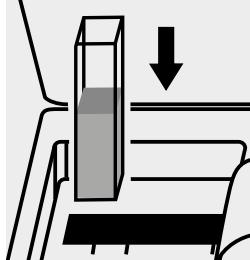
Inserire la cuvetta nell'alloggiamento cuvette.
