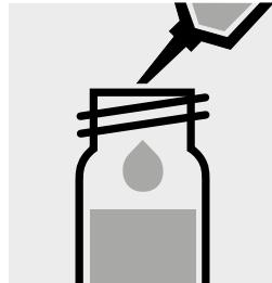
Aggiungere 0,50 ml di **Sn-1K** con pipetta, chiudere la cuvetta con tappo a vite e mescolare.
