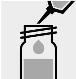
Pipettare 2,0 ml del campione in una provetta con tappo a vite.
