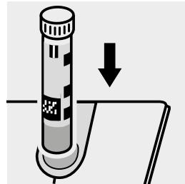
Inserire la cuvetta del bianco nell'alloggiamento cuvette.
