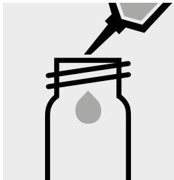
Pipettare 10 ml di campione in una cuvetta rotonda vuota (cuvetta vuote, art. 1.14724).
