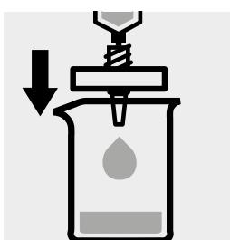
Filtrare 10 - 20 ml della soluzione preparata con filtro a membrana in un becher pulito ed asciutto.
