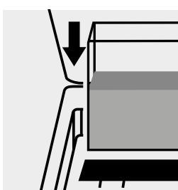
Inserire la cuveta del bianco nell'alloggiamento cuvette.
