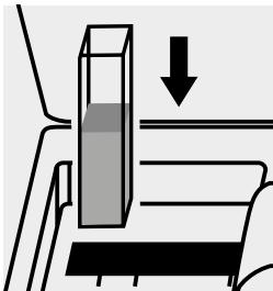
Inserire la cuvetta nell'alloggiamento cuvette.
