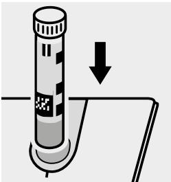
Inserire la cuvetta nell'alloggiamento cuvette.
