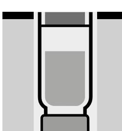
Dopo averla capovolta, riscaldare la cuvetta di reazione nel termoreattore per 2 ore a 120 °C.
