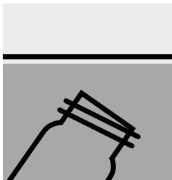
Immergere completamente una cuvetta di reazione dentro al campione acqueo da analizzare, evitando la formazione di bolle d'aria all'interno della cuvetta.
