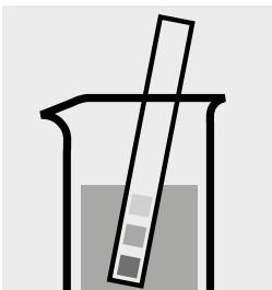
Controllare il pH del campione. Intervallo necessario: pH 1–10
