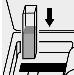
Inserire la cuvetta nell'alloggiamento cuvette.
