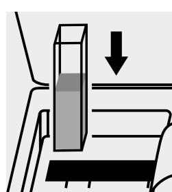
Inserire la cuvetta nell'alloggiamento cuvette.
