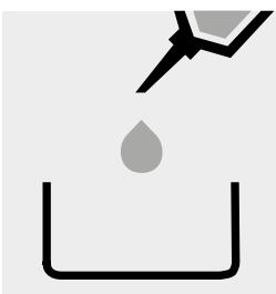
Pipettare 25,0 ml di campione in un vassoio di platino ed eseguire un incenerimento secondo EN 1136 [3].
