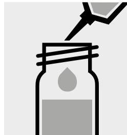
Aggiungere 5,0 ml di acqua destillata (si consiglia Acqua per analisi EMSURE®, art. 1.16754) con pipetta, chiudere con tappo a vite e mescolare.
