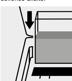
Inserire la cuvetta nell'alloggiamento cuvette.
