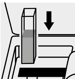
Inserire la cuvetta nell'alloggiamento cuvette.
