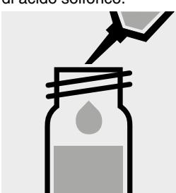
Aggiungere 7,0 ml di acqua distillata in la seconda cuvetta di reazione, chiudere con tappo a vite e mescolare.
