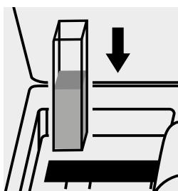
Inserire la cuvetta nell'alloggiamento cuvette.
