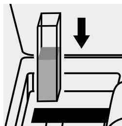
Inserire la cuvetta nell'alloggiamento cuvette.
