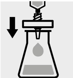
Filtrare la soluzione campione su filtro a membrana con dimensione dei pori di 0,45 µm.
