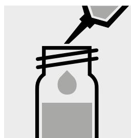
Aggiungere 0,20 ml di **Oxyscav 2** con pipetta, chiudere con tappo a vite e mescolare.
