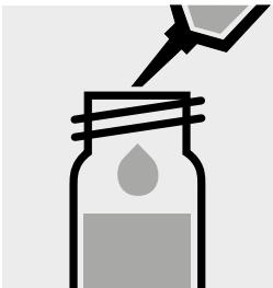
Pipettare 1,0 ml di NO<sub>3</sub>-1K in una cuvetta di reazione, **non mescolare!**
