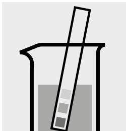
Controllare il pH del campione. Intervallo necessario: pH 6–8
