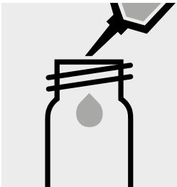
Pipettare 4,0 ml di **AC-1** in una cuvetta rotonda.
