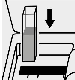
Inserire la cuvetta nell'alloggiamento cuvette.
