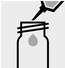
Pipettare 10 ml di campione in un contenitore di plastico (tubi a fondo piatto, art. 1.17988).
