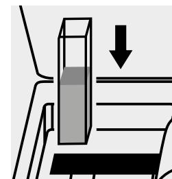
Inserire la cuvetta nell'alloggiamento cuvette.
