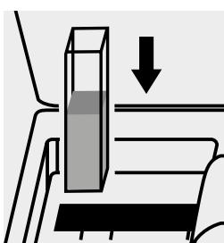
Inserire la cuvetta nell'alloggiamento cuvette. La misurazione avviene automaticamente.
