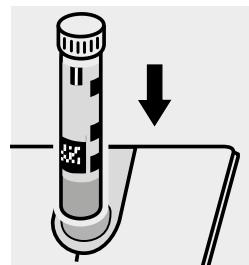
Inserire la cuvetta nell'alloggiamento cuvette.
