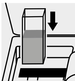
Inserire la cuvetta nell'alloggiamento cuvette.
