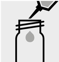
Pipettare 0,75 ml di OA-1 in una cuvetta rotonda.
