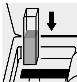
Inserire la cuvetta nell'alloggiamento cuvette.
