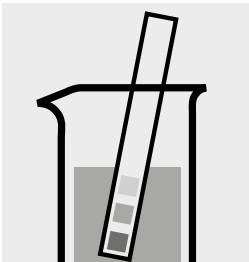
Controllare il pH del campione. Intervallo necessario: pH 4–9
