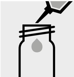
Pipettare 0,50 ml di OA-1K in una cuvetta rotonda.
