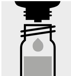
Aggiungere 4 gocce di pH-1, chiudere la cuvetta con tappo a vite e mescolare. **Attenzione!** Il flacone di reattivo va **assolutamente** tenuto in posizione verticale!
