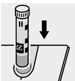
Inserire la cuvetta nell'alloggiamento cuvette.
