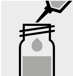
Pipettare 4,0 ml di campione in una cuvetta di reazione, chiudere con tappo a vite e mescolare.
