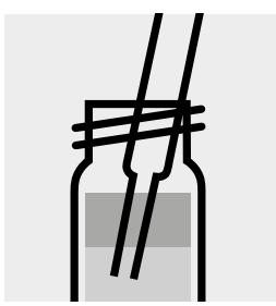
Prelevare 0,5 ml dello strato inferiore limpido usando una pipetta.
