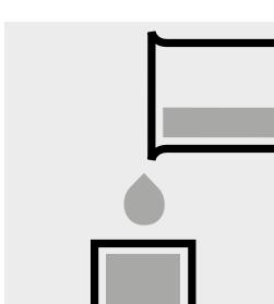
Trasferire le due soluzioni in due cuvette da 50 mm.
