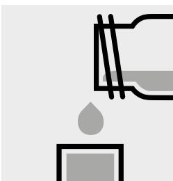
Trasferire la soluzione (se possibile senza sedimentazione) nella cuvetta rettangolare.
