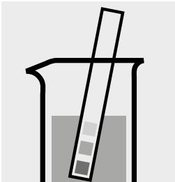
Controllare il pH del campione. Intervallo necessario: pH 2,5–7,5
