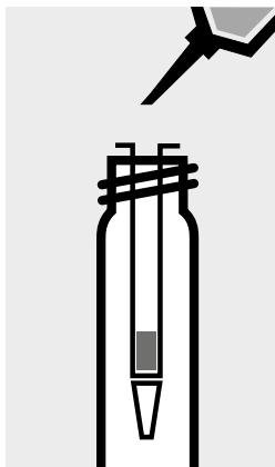
Lasciar percolare completamente attraverso la colonna rispettivamente 3 x 1 ml di **AOX-3**. Eliminare la soluzione di lavaggio.
