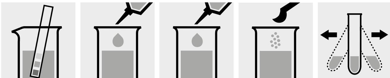
Controllare il pH del campione. Intervallo necessario: pH 4–13
