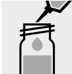
Aggiungere 0,50 ml di T-1K con pipetta e chiudere la cuvetta con tappo a vite.
