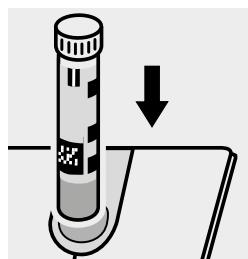
Inserire la cuveta del bianco nell'alloggiamento cuvette. Far coincidere la tacca della cuvetta con l'indicatore del fotometro.
