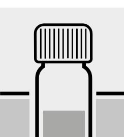
Incubare la provetta in un bagno d'acqua secondo EN 1141 [1] o art. 64 del LFGB 31.00-7 [2].
