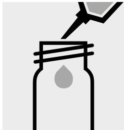
Pipettare 5,0 ml del campione diluito 1:500 in una cuvetta rotonda vuota (cuvette vuote, art. 1.14724).
