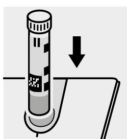
Inserire la cuvetta nell'alloggiamento cuvette.
