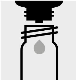
Mettere 2 gocce di Mo-1K in una cuvetta di reazione e mescolare.
