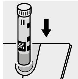
Inserire la cuvetta nell'alloggiamento cuvette. Far coincidere la tacca della cuvetta con l'indicatore del fotometro.
