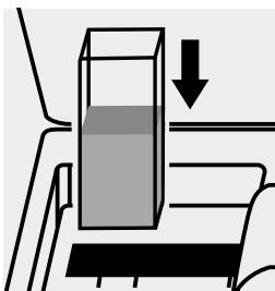
Inserire la cuvetta nell'alloggiamento cuvette.
