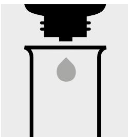
Versare 6 gocce di  $\text{Cl}_2\text{-}1$  in una provetta.
