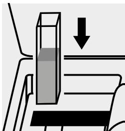
Inserire la cuvetta nell'alloggiamento cuvette. La misurazione avviene automaticamente.
