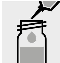
Pipettare 5,0 ml di campione in una cuvetta di reazione, chiudere con tappo a vite e mescolare.
