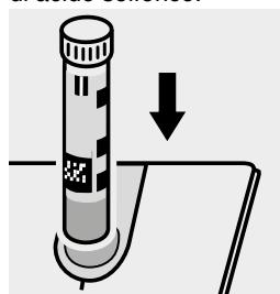
Inserire la cuvetta nell'alloggiamento cuvette.
