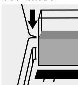
Inserire la cuvetta del bianco nell'alloggiamento cuvette.
