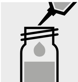
Aggiungere 0,20 ml di **reattivo 2** con pipetta. Chiudere la cuvetta con tappo a vite e mescolare.
