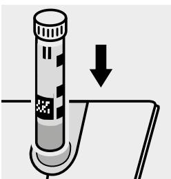
Inserire la cuveta del campione nell'alloggiamento cuvette. Far coincidere la tacca della cuvetta con l'indicatore del fotometro.
