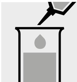
Pipettare 2,0 ml di F-1 in una provetta.
