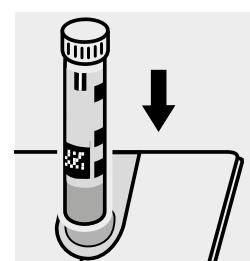
Inserire la cuvetta nell'alloggiamento cuvette.
