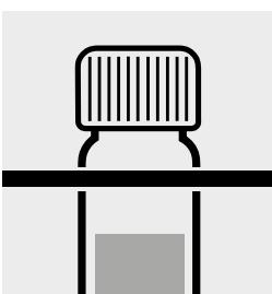
Rimettere la cuvetta sul portaprovette e lasciarla raffreddare completamente a temperatura ambiente (**molto importante!**).
