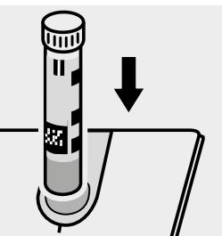
Inserire la cuvetta nell'alloggiamento cuvette.
