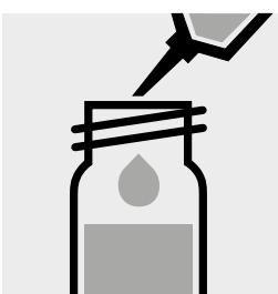
Aggiungere 1,0 ml di OA-4K con pipetta, chiudere la cuvetta con tappo a vite e mescolare.
