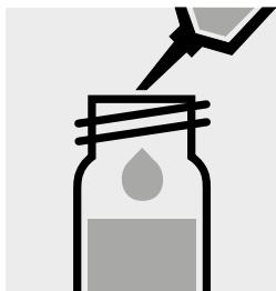
Aggiungere 1,0 ml di **acido fosforico** (art. 1.00573) con pipetta. Chiudere la cuvetta con tappo a vite e mescolare.
