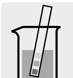
Controllare il pH del campione. Intervallo necessario: pH 2–8
