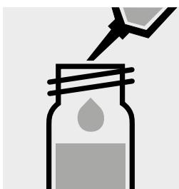
Pipettare 1,0 ml di campione in una cuvetta, chiudere con tappo a vite e mescolare.
