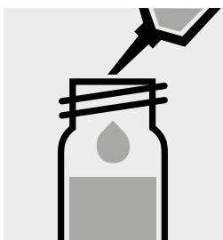
Pipettare 5,0 ml di campione in una cuvetta di reazione, **non mescolare!**
