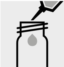
Pipettare 4,0 ml di NO<sub>3</sub>-1 in una cuvetta rotonda vuota ed asciutta (cuvette vuote, art. 1.14724).
