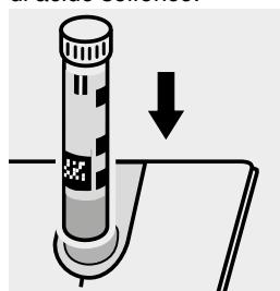
Inserire la cuvetta nell'alloggiamento cuvette.
