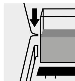
Inserire la cuvetta del bianco nell'alloggiamento cuvette.
