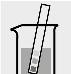
Controllare il pH del campione. Intervallo necessario: pH 4,5–8,0 Se necessario correggere il pH aggiungendo goccia a goccia una soluzione diluita di idrossido di sodio o di acido solforico.
