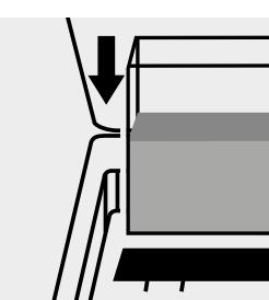
Inserire la cuvetta del campione nell'alloggiamento cuvette.
