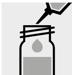
Aggiungere 1,0 ml di OA-5 con pipetta, chiudere la cuvetta con tappo a vite e mescolare.
