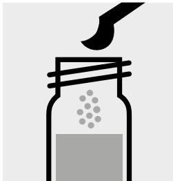
Mettere 1 micro-cucchiaino raso grigia di SO<sub>3</sub>-1K in una cuvetta di reazione e chiudere con tappo a vite.
