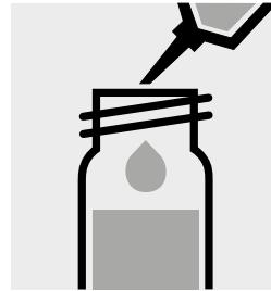
Aggiungere 8,0 ml di **soluzione di idrossido di sodio 2,5 mol/l** con pipetta e mescolare.
