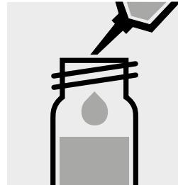
Pipettare 0,50 ml di Zn-2K in una cuvetta di reazione, chiudere con tappo a vite e mescolare.
