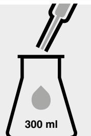
Dispensare 20 ml di acqua distillata (si consiglia Acqua per cromatografia LiChrosolv®, art. 1.15333) con una pipetta di vetro in un secondo matraccio di Erlenmeyer da 300 ml con cono NS 29/32.
