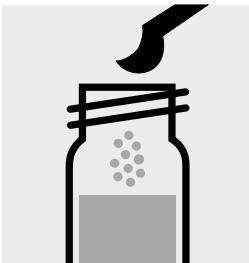
Mettere 1 microcucchiaino raso di NO<sub>3</sub>-1K in una cuvetta di reazione e chiudere.
