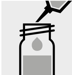
Aggiungere 10 ml di campione con pipetta, chiudere la cuvetta con tappo a vite.
