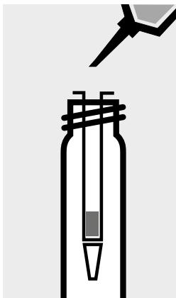
Lasciar percolare completamente attraverso la colonna rispettivamente 3 x 1 ml di **AOX-2**. Eliminare la soluzione di lavaggio.
