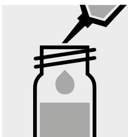
Pipettare 5,0 ml di campione in una provetta con tappo a vite.
