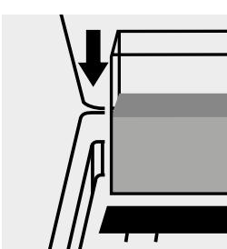
Inserire la cuvetta del bianco nell'alloggiamento cuvette.
