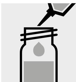
Aggiungere 8,0 ml di **soluzione di idrossido di sodio 2,5 mol/l** con pipetta e mescolare.
