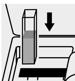
Inserire la cuvetta nell'alloggiamento cuvette.
