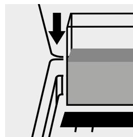
Inserire la **cuvetta A** nell'alloggiamento cuvette. La misurazione avviene automaticamente.
