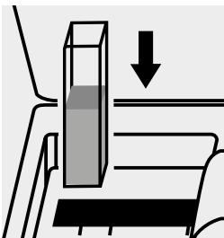
Inserire la cuvetta nell'alloggiamento cuvette.
