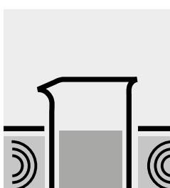
Degassare per 3 minuti in un bagno ad ultrasuoni.
