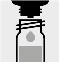
Mettere 6 gocce di Sn-1K in una cuvetta di reazione, chiudere con tappo a vite e mescolare.
