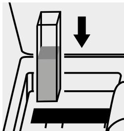
Inserire la cuvetta nell'alloggiamento cuvette.
