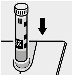
Inserire la cuvetta nell'alloggiamento cuvette.
