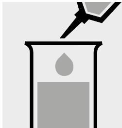
Aggiungere 10 ml di campione con pipetta in una provetta e mescolare.
