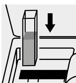
Inserire la cuvetta nell'alloggiamento cuvette.
