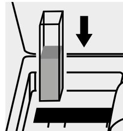
Inserire la cuvetta B nell'alloggiamento cuvette. La misurazione avviene automaticamente.
