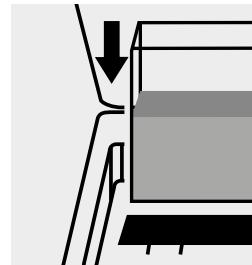
Inserire la cuvetta nell'alloggiamento cuvette.
