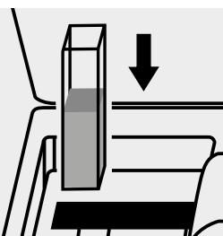
Inserire la cuvetta nell'alloggiamento cuvette.
