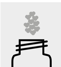
Pesare, con l'approssimazione di 1 mg, circa 2 g di campione in un flacone da laboratorio DURAN® e processare secondo l'art. 64 del LFGB 06.00-8, capitolo 7.1 [1].
