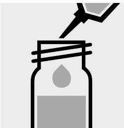
Pipettare 10 ml di campione in una cuvetta di reazione, chiudere con tappo a vite e mescolare.
