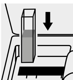
Inserire la cuvetta nell'alloggiamento cuvette.
