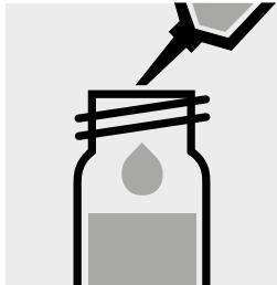
Aggiungere 0,20 ml di Cd-1K con pipetta, chiudere la cuvetta con tappo a vite e mescolare.
