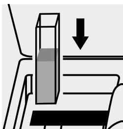
Inserire la cuvetta nell'alloggiamento cuvette.
