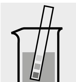
Controllare il pH del campione. Intervallo necessario: pH 5 – 10
