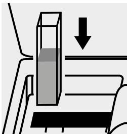
Inserire la cuvetta nell'alloggiamento cuvette.
