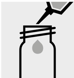
Pipettare 4,0 ml di campione in una cuvetta rotonda vuota (cuvette vuote, art. 1.14724).
