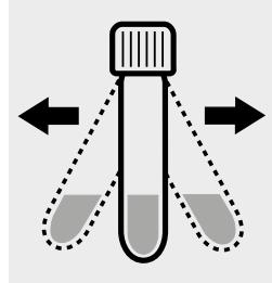
Agitare con forza la provetta per 1 minuto. Lasciare riposare per la separazione delle fasi.
