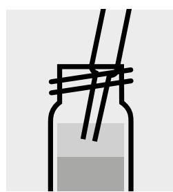
Prelevare lo strato superiore limpido usando una pipetta.
