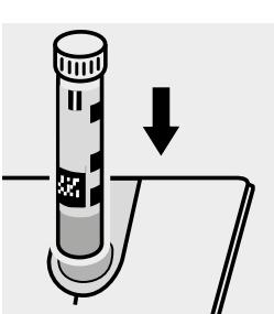
Inserire la cuvetta nell'alloggiamento cuvette. Far coincidere la tacca della cuvetta con l'indicatore del fotometro.
