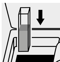
Inserire la cuvetta nell'alloggiamento cuvette.
