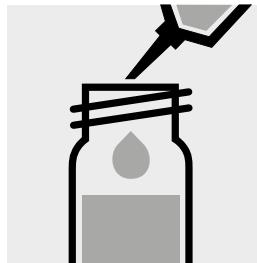
Aggiungere 0,50 ml di **Ca-2K** con pipetta, chiudere la cuvetta con tappo a vite e mescolare.
