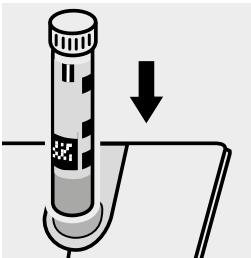
Inserire la cuvetta del campione nell'alloggiamento cuvette.
