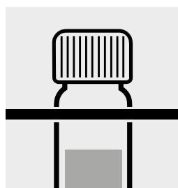
Rimettere la cuvetta sul portaprovette e lasciarla raffreddare completamente a temperatura ambiente (**molto importante!**).
