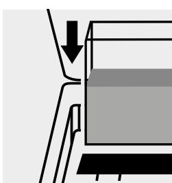
Inserire la cuveta del campione nell'alloggiamento cuvette.
