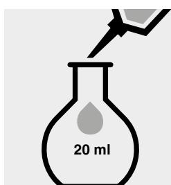
Versare 10 ml di **reattivo di molibdato di sodio/acido ascorbico** in un matraccio graduato da 20 ml.
