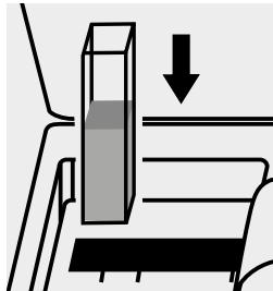
Inserire la cuvetta nell'alloggiamento cuvette.
