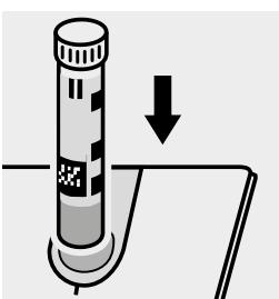
Inserire la cuvetta nell'alloggiamento cuvette.
