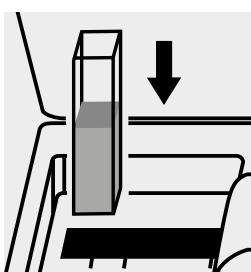
Inserire la cuvetta del campione nell'alloggiamento cuvette.
