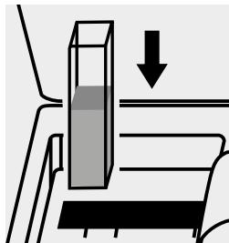
Inserire la cuvetta nell'alloggiamento cuvette.
