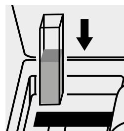
Inserire la cuvetta nell'alloggiamento cuvette.
