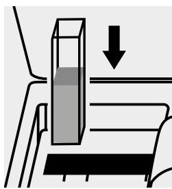
Inserire la cuvetta nell'alloggiamento cuvette.
