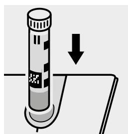
Inserire la cuvetta nell'alloggiamento cuvette.
