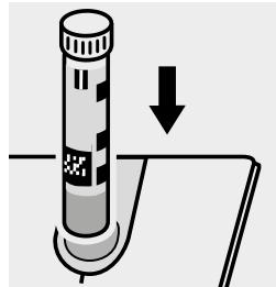
Inserire la cuvetta nell'alloggiamento cuvette.
