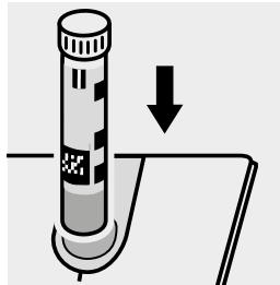
Inserire la cuvetta nell'alloggiamento cuvette.
