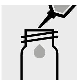
Pipettare 5,0 ml di campione preparato in una cuvetta di reazione, chiudere con tappo a vite e sciogliere la sostanza solida.
