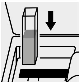
Inserire la cuvetta nell'alloggiamento cuvette.
