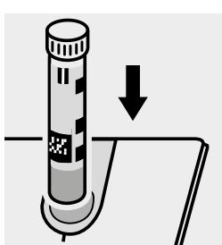
Inserire la cuvetta nell'alloggiamento cuvette.
