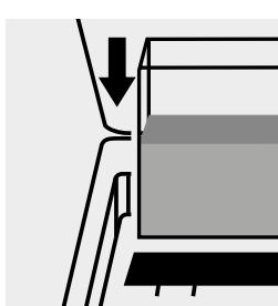
Inserire la cuvetta del campione nell'alloggiamento cuvette.
