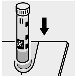
Inserire la cuvetta nell'alloggiamento cuvette.
