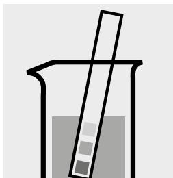
Controllare il pH del campione. Intervallo necessario: pH 1–13
