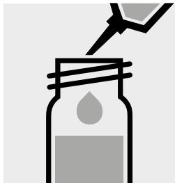
Aggiungere 5 ml di **acido solforico al 40 %** con pipetta. Chiudere la cuvetta con tappo a vite e mescolare.
