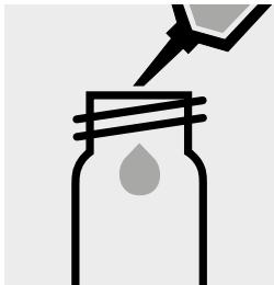
Pipettare 10 ml di campione in una cuvetta rotonda vuota (cuvette vuote, art. 1.14742).
