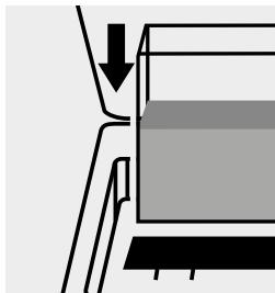
Inserire la cuvetta nell'alloggiamento cuvette.
