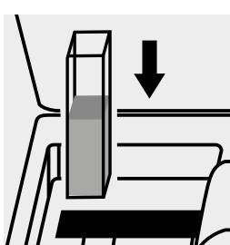
Inserire la cuvetta nell'alloggiamento cuvette.
