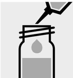
Pipettare 1,0 ml di campione in una cuvetta di reazione, **non mescolare!**
