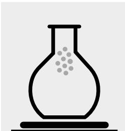
Pesare, con l'approssimazione di 0,1 mg, il campione polverizzato in un matraccio.
