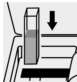
Inserire la cuvetta nell'alloggiamento cuvette.
