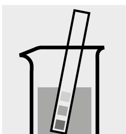
Controllare il pH del campione. Intervallo necessario: pH 3–6
