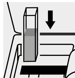
Inserire la cuvetta nell'alloggiamento cuvette.
