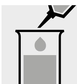
Aggiungere 0,25 ml di Mn-4 con pipetta e mescolare con precauzione (formazione de schiuma! occhiali di protezione!).
