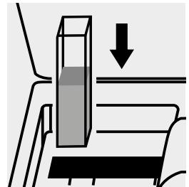
Inserire la cuvetta nell'alloggiamento cuvette. La misurazione avviene automaticamente.
