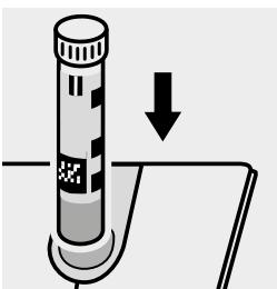
Inserire la cuvetta nell'alloggiamento cuvette.
