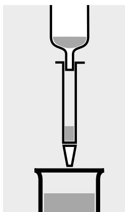
Rimuovere la chiusura della colonna e lasciar percolare completamente il campione.
