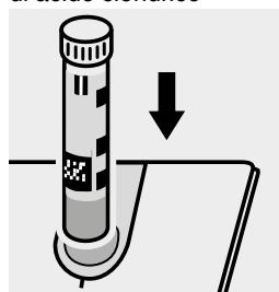
Inserire la cuvetta nell'alloggiamento cuvette.
