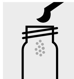
Mettere 1 microcucchiaino raso blu di Cl<sub>2</sub>-1 in una cuvetta rotonda.
