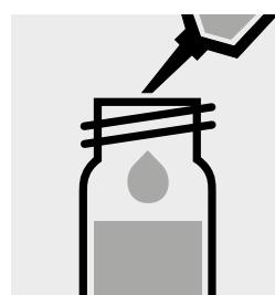
Aggiungere 2,0 ml di **acido cloridrico 6 mol/l** con pipetta, chiudere e mescolare.
