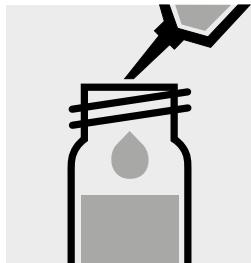
Aggiungere 1,0 ml di **Ca-1K** con pipetta, chiudere la cuvetta con tappo a vite e mescolare.
