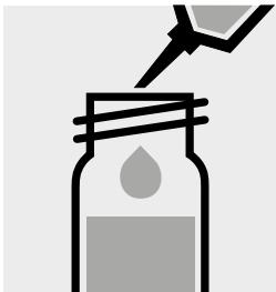
Aggiungere 0,50 ml di **AC-2** con pipetta, chiudere la cuvetta con tappo a vite e mescolare.
