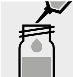
Aggiungere 1,0 ml di campione con pipetta. **Attenzione, la cuvetta diventa calda!**
