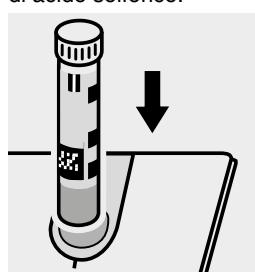
Inserire la cuvetta nell'alloggiamento cuvette.
