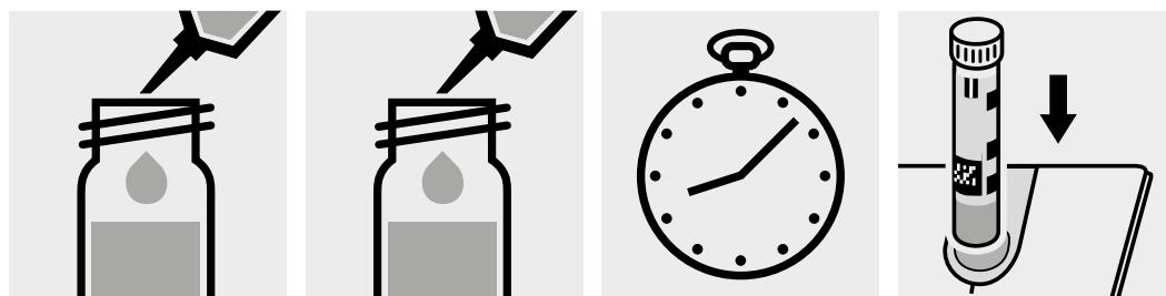
Pipettare 0,20 ml di **AOX-1K** in una cuvetta di reazione e mescolare.
