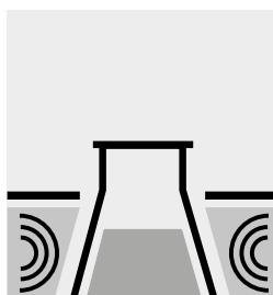
Degassare il campione in un bagno ad ultrasuoni.
