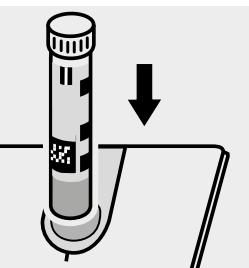
Inserire la cuvetta nell'alloggiamento cuvette.
