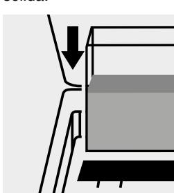
Inserire la cuvetta del campione nell'alloggiamento cuvette.
