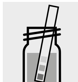
Controllare il pH del campione. Risultato necessario: pH 6,5
