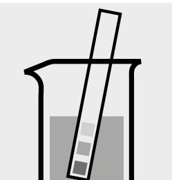
Controllare il pH del campione. Intervallo necessario: pH 4–13
