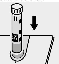
Inserire la cuvetta nell'alloggiamento cuvette.
