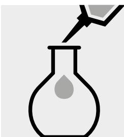
Se necessario, diluire il campione con acqua distillata (si consiglia Acqua per analisi EMSURE®, art. 1.16754).
