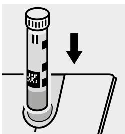
Inserire la cuvetta nell'alloggiamento cuvette.
