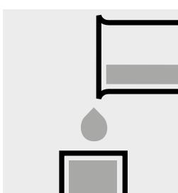
Trasferire il campione di misurazione nella cuvetta di quarzo.
