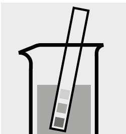
Controllare il pH del campione. Intervallo necessario: pH 1–12
