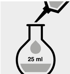
Pipettare 10 ml di campione in un matraccio graduato da 25 ml.
