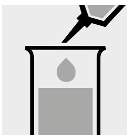
Pipettare 5,0 ml di NH<sub>4</sub>-1 in una provetta.
