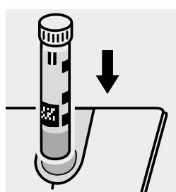
Inserire **senza agitando di nuovo** la cuvetta nell'alloggiamento cuvette. Far coincidere la tacca della cuvetta con l'indicatore del fotometro.
