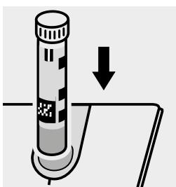
Inserire la cuvetta nell'alloggiamento cuvette.
