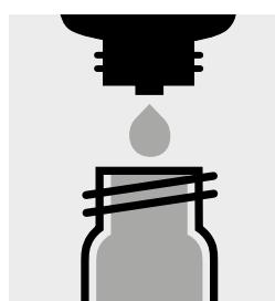
Aggiungere 10 gocce di O<sub>2</sub>-3K, chiudere la cuvetta con tappo a vite, mescolare e pulire la superficie esterna.
