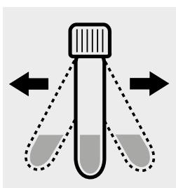
Agitare con forza la provetta per 30 secondi. Lasciare riposare per la separazione delle fasi.
