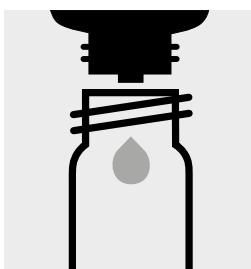
Aggiungere 6 gocce di Cr-3K in una cuvetta di reazione e chiudere con tappo a vite ed **agitare lentamente**.
