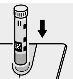
Inserire la cuvetta nell'alloggiamento cuvette.
