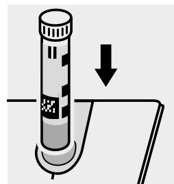
Eseguire la determinazione del **fosforo totale** (v. la metodo analitico "Determinazione del fosforo totale" con 1.14543). = **cuvetta Σ P**
