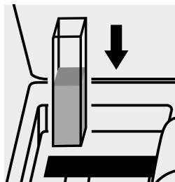
Inserire la cuvetta nell'alloggiamento cuvette.
