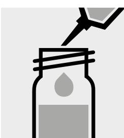
Pipettare 1,0 ml di campione preparato in una provetta con tappo a vite.
