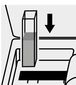
Inserire la cuvetta nell'alloggiamento cuvette.
