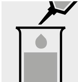
Aggiungere 5,0 ml di acqua distillata (si consiglia Acqua per analisi EMSURE®, art. 1.16754) con pipetta in una seconda provetta e mescolare.
