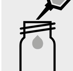
Pipettare 5,0 ml di **campione preparato** in una cuvetta rotonda vuota (cuvette vuote, art. 1.14724).
