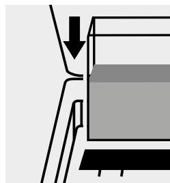
Inserire la cuvetta del campione nell'alloggiamento cuvette.
