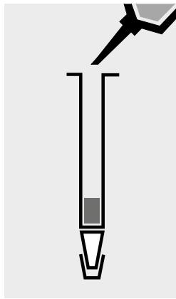
Chiudere la colonna nella parte inferiore. Aggiungere 1 ml di **AOX-3**. Chiudere la colonna nella parte superiore e agitare delicatamente onde rimuovere le bolle d'aria. Aprire la colonna nella parte superiore e riempire fino all'orlo con **AOX-3**.
