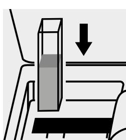
Inserire la cuvetta nell'alloggiamento cuvette.
