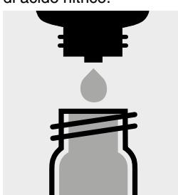
Aggiungere 5 gocce di O<sub>2</sub>-2K, chiudere la cuvetta con tappo a vite ed agitare per 10 secondi.
