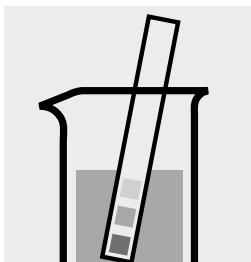
Controllare il pH del campione. Intervallo necessario: pH 2–5
