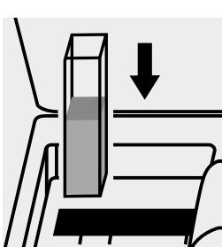
Inserire la cuvetta del bianco nell'alloggiamento cuvette.
