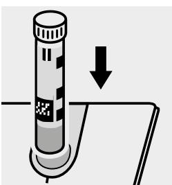
Inserire la cuvetta nell'alloggiamento cuvette.
