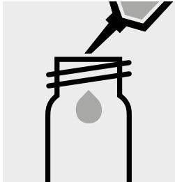
Pipettare 10 ml di campione in un tubo di saggio (tubi a fondo piatto, art. 1.14902).
