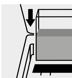
Inserire la cuvetta del bianco nell'alloggiamento cuvette.
