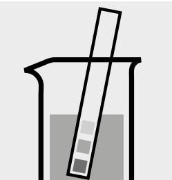
Controllare il pH del campione. Intervallo necessario: pH <3
