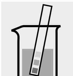
Controllare il pH del campione. Intervallo necessario: pH 2–10
