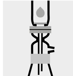
Filtrare la soluzione preparata sotto vuoto con filtro a membrana in un matraccio di Erlenmeyer pulito ed asciutto.
