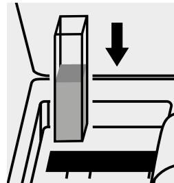
Inserire la cuvetta nell'alloggiamento cuvette.
