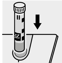
Inserire la cuvetta nell'alloggiamento cuvette.
