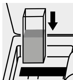
Inserire la cuvetta nell'alloggiamento cuvette.
