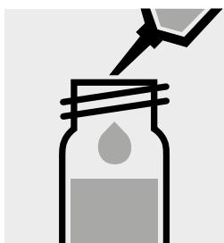
Pipettare 0,100 ml di acqua distillata (si consiglia Acqua per analisi EMSURE®, art. 1.16754) in una provetta con tappo a vite.
