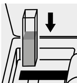
Inserire la cuvetta nell'alloggiamento cuvette.
