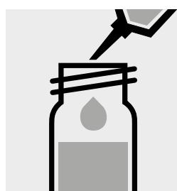
Pipettare 2,0 ml di acqua distillata (si consiglia Acqua per analisi EMSURE®, art. 1.16754) in un recipiente sigillabile (20 ml).
