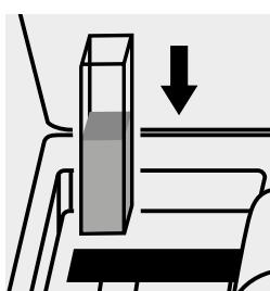
Inserire la cuvetta nell'alloggiamento cuvette. La misurazione del valore bianco avviene automaticamente.
