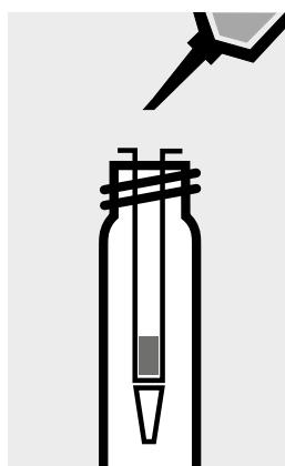
Disconnectere la colonna dal serbatoio e lasciar percolare completamente attraverso la colonna rispettivamente 3 x 1 ml di **AOX-3**. Eliminare la soluzione di lavaggio.
