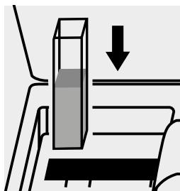
Inserire la cuvetta nell'alloggiamento cuvette.
