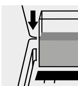
Inserire la cuvetta del bianco nell'alloggiamento cuvette.
