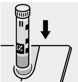
Inserire la cuvetta nell'alloggiamento cuvette.
