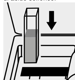
Inserire la cuvetta nell'alloggiamento cuvette.
