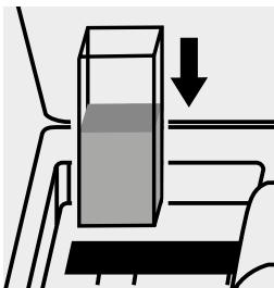
Inserire la cuvetta nell'alloggiamento cuvette.
