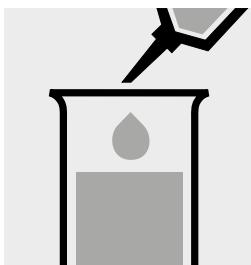
Pipettare 5,0 ml di acqua distillata (si consiglia Acqua per analisi EMSURE®, art. 1.16754) in una provetta.
