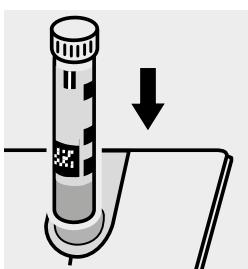
Inserire la cuvetta nell'alloggiamento cuvette.
