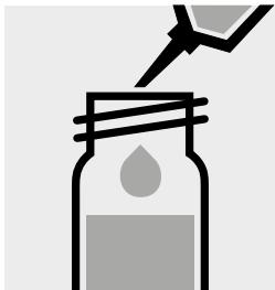
Aggiungere 1,0 ml di **NO<sub>3</sub>-1K** con pipetta, chiudere la cuvetta con tappo a vite e mescolare. **Attenzione, la cuvetta diventa calda!**
