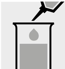
Pipettare 0,50 ml di campione in una provetta.
