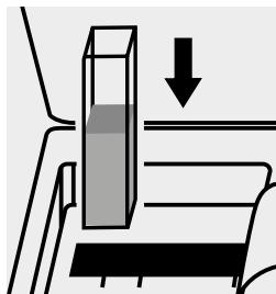
Inserire la cuvetta nell'alloggiamento cuvette.
