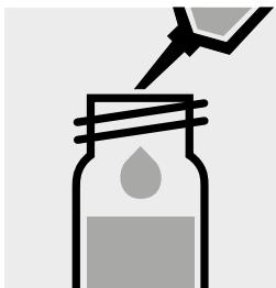
Aggiungere 3,0 ml di campione con pipetta, chiudere la cuvetta e mescolare.
