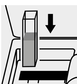
Inserire la cuvetta nell'alloggiamento cuvette.
