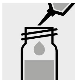
Aggiungere 5,0 ml di campione con pipetta nella cuvetta, chiudere con tappo a vite e mescolare.
