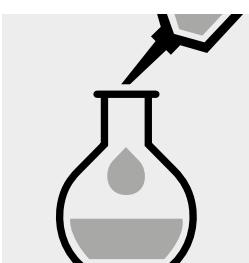
Portare a volume la soluzione nel matraccio con **isoottano per spettroscopia Uvasol®** (art. 1.04718) o **cicloesano per spettroscopia Uvasol®** (art. 1.02822) e mescolare.
