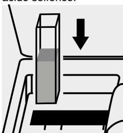
Inserire la cuvetta nell'alloggiamento cuvette.
