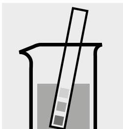
Controllare il pH del campione. Intervallo necessario: pH 2–11
