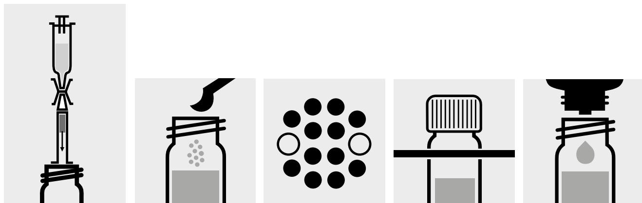
Fissare il raccordo all'estremità inferiore della colonna. Con una siringa di plastica, sciacquare il carbone in una cuvetta vuota nella colonna con 10 ml di **AOX-5**.
