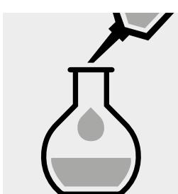
Portare a volume la soluzione nel matraccio con **cicloesano per spettroscopia Uvasol®** (art. 1.02822) e mescolare.
