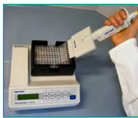
5. Immobilisierung (Binden des „Sandwichs“ an Affinitätsplatte, 10 min)
