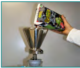
1. Probe filtrieren (250 – 1000 ml AfG, 15 min)
