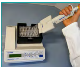
7. Waschen (Entfernen ungebundener Komponenten, 2x 1min)
