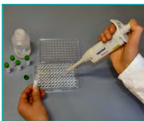
4. HybriScan®-Testlösung (Binden der Probe an spezifische Sonden, 10 min)
