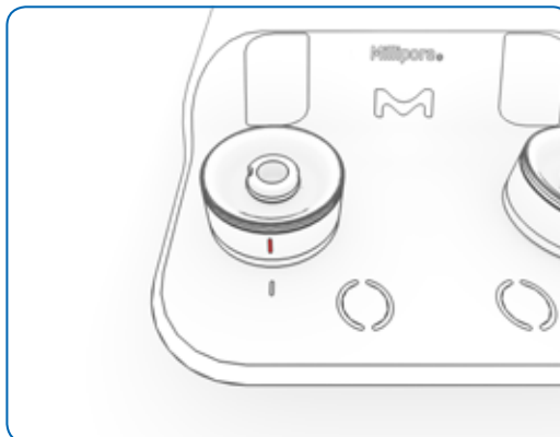
图13:锁定的泵头上的标记与泵体上的标记对齐。
