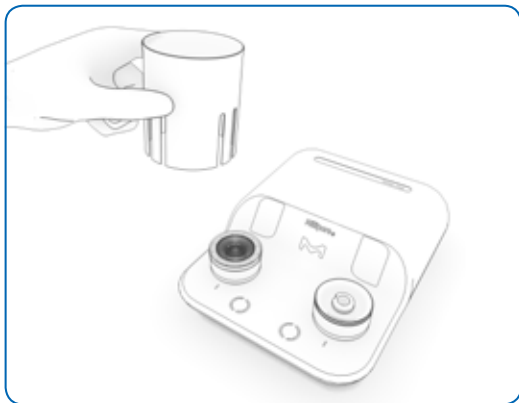
图28:使用拆卸工具拆除过滤杯底座——第1部分
