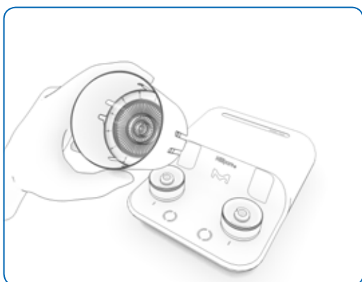
图30:使用拆卸工具拆除过滤杯底座——第3部分
