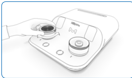
图27:扭转过滤杯底座即可将其取下
