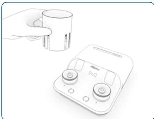
图29:使用拆卸工具拆除过滤杯底座——第2部分
