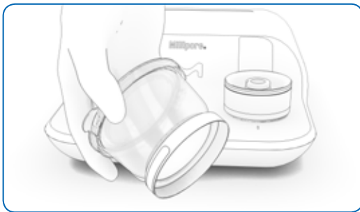
图20:检查滤膜的凸起形状
