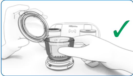
图22:取下过滤装置盖子的正确方法
