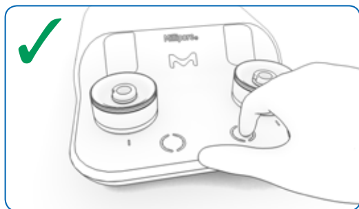
图4:正确启动或停止泵的手指位置
