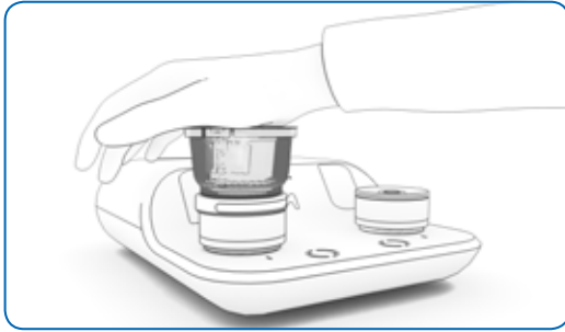
图18:用手掌牢牢按下过滤装置的盖子将其锁定
