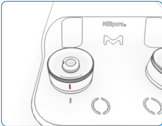
图47:锁定的泵头上的标记与泵体上的标记对齐。
