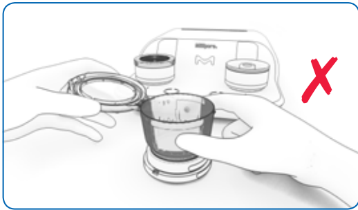
图23:取下过滤装置盖子的错误方法
