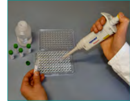
3. HybriScan®-Testlösung (Binden der Probe an spezifische Sonden, 10 min)
