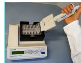
6. Waschen (Entfernen ungebundener Komponenten, 2x 1 min)
