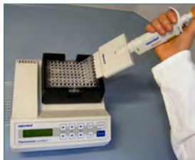
4. Waschen (Entfernen ungebundener Komponenten, 2 min)
