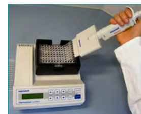
6. Waschen (Entfernen ungebundener Komponenten, 2x 1min)
