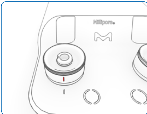
Abbildung 47: Die Markierung auf einem arretierten Pumpenkopf ist auf die Markierung am Pumpenkörper ausgerichtet.
