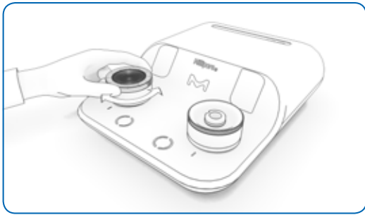
Abbildung 27: Abnehmen der Membranauflage durch Drehen
