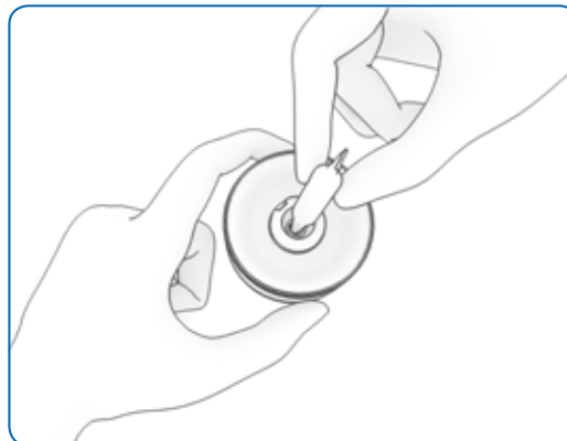
Abbildung 41: Installation des Rückschlagventils mithilfe des Werkzeugs – Teil 2
