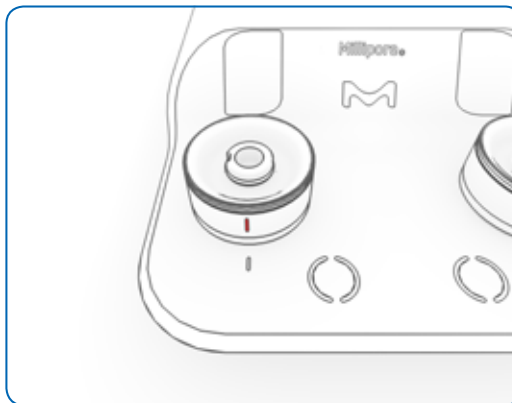
Abbildung 13: Die Markierung auf einem arretierten Pumpenkopf ist auf die Markierung am Pumpenkörper ausgerichtet
