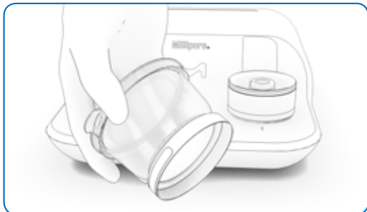
Abbildung 20: Überprüfung der konvexen Form der Membran
