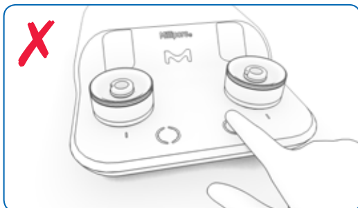
Abbildung 5: FALSCHER Fingerposition – keine Aktivierung, da der Finger die Umrandung berührt
