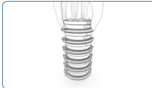
Abbildung 26: Es können bis zu sechs Agarplatten mit Membranfilter gestapelt werden
