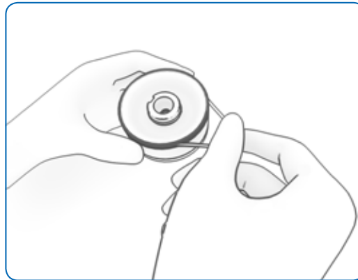
Abbildung 36: Abnehmen der äußeren Dichtung
