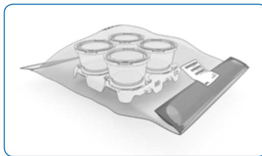
Abbildung 14: Aufbewahrung unbenutzter Filtrationseinheiten
