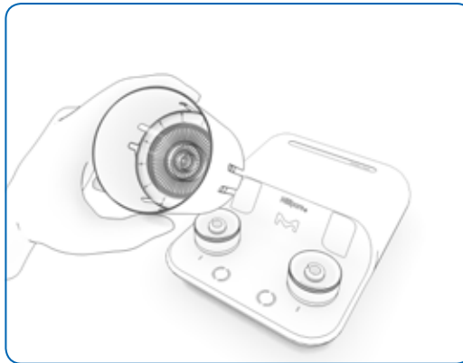
Abbildung 30: Abnehmen der Membranauflage mit der Trennvorrichtung – Teil 3
