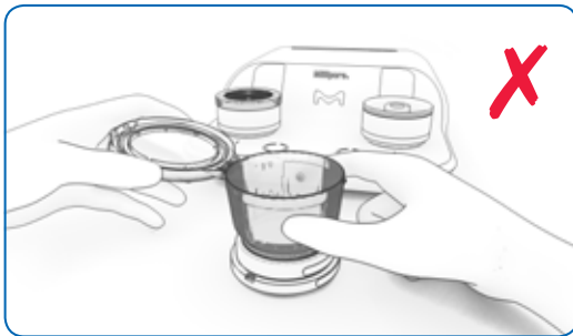
Abbildung 23: FALSCHES Abnehmen des Deckels von der Filtrationseinheit
