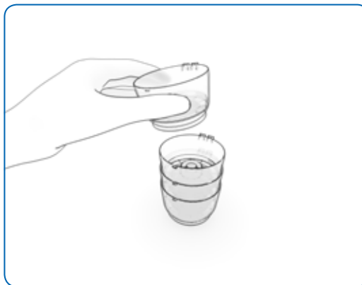
Abbildung 31: Stapeln gebrauchter Trichter und Membranauflagen zur Entsorgung
