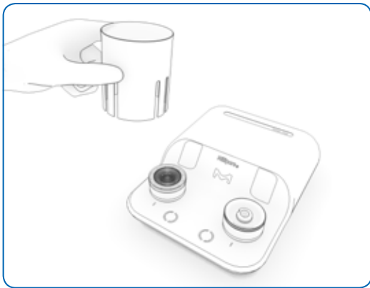
Abbildung 28: Abnehmen der Membranauflage mit der Trennvorrichtung – Teil 1
