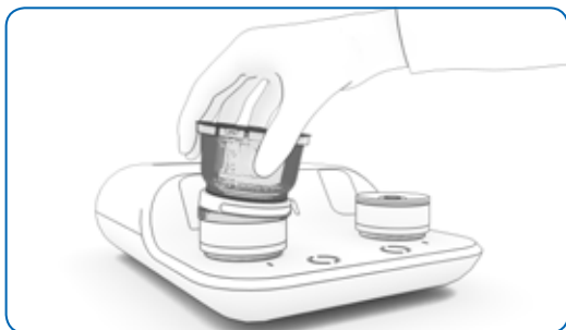
Abbildung 19: Kippen der Filtrationseinheit zum Abnehmen
