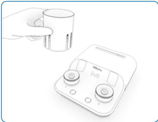
Abbildung 29: Abnehmen der Membranauflage mit der Trennvorrichtung – Teil 2
