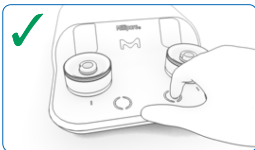
Abbildung 4: KORREKTE Fingerposition zum Starten oder Stoppen der Pumpe
