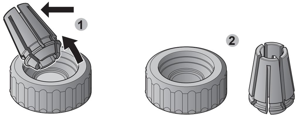
4. Desenrosque por completo el tornillo de fijación del brazo y retire los componentes.
