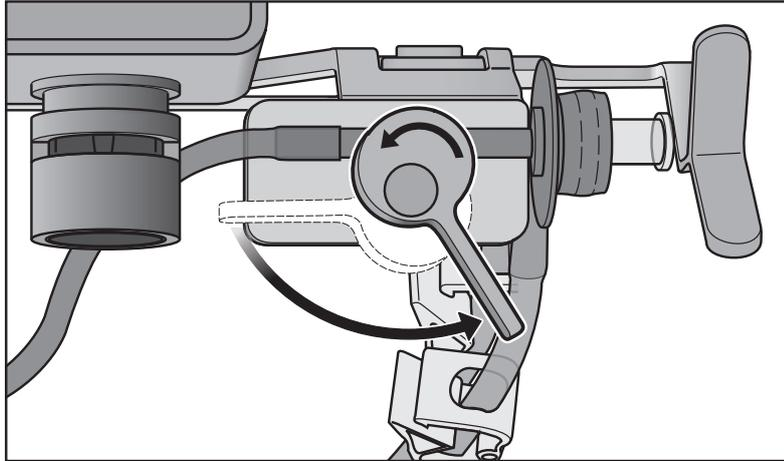
5. Coloque el tubo de silicona por encima del surco del sistema de sujeción para el tubo de la válvula automática.
