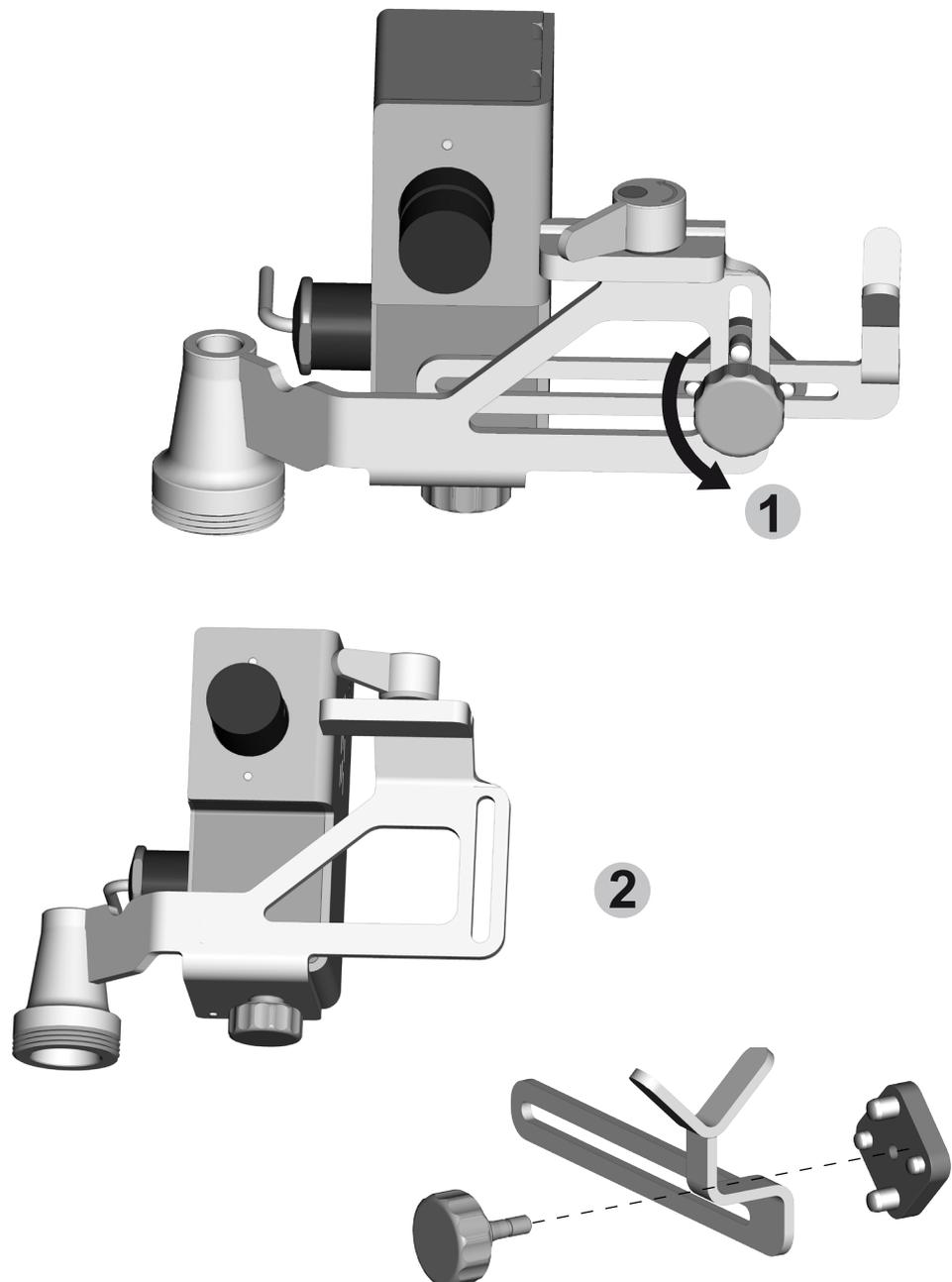
5. Desenrosque por completo el tornillo de fijación de la válvula y retire el cuerpo de la válvula del soporte.
