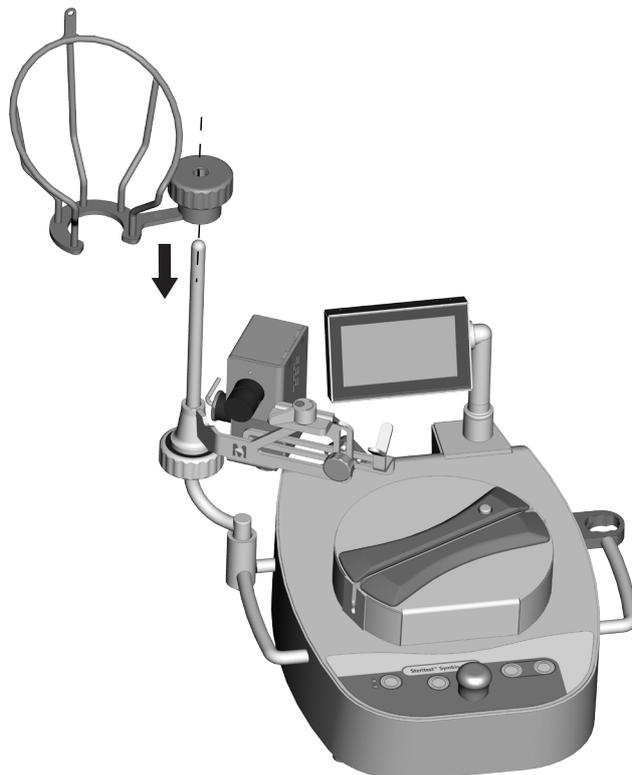
8. Conecte el soporte de jeringas al puerto específico localizado en la unidad central de comunicación de Steritest™ Symbio.
