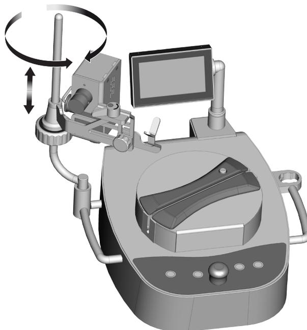
6. Asegure la posición del soporte de jeringas apretando el tornillo de fijación a la barra.
