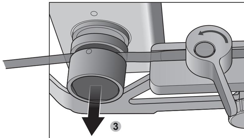
7. Instale el tubo de la cámara de filtración en el cabezal de la bomba y cierre el cabezal (véase el **Manual del usuario de las bombas Steritest™ Symbio** disponible en [www.millipore.com/steritest-symbio](http://www.millipore.com/steritest-symbio))
