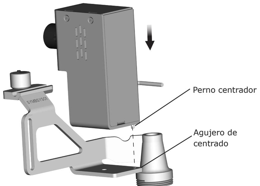
3. Introduzca y enrosque el tornillo de fijación de la válvula automática para asegurar el cuerpo de la válvula en su posición.
