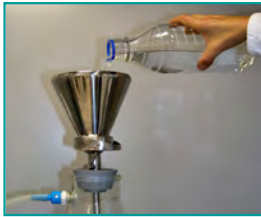
1. Probe filtrieren (1000 ml Wasser, 15 min)
