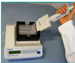
7. Waschen (Entfernen ungebundener Komponenten, 2x1 min)
