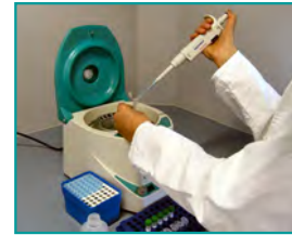
3. Zentrifugieren/Zellyse (2 ml Probe, 13.000 rpm; 37°C, 45-60 min)
