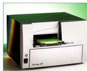
8. Messsignal fotometrisch auslesen
