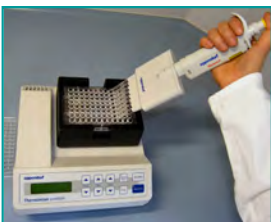
7. Waschen (Entfernen ungebundener Komponenten, 2x 1min)
