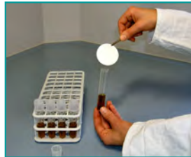
2. Filter inkubieren (z.B. SSL-Broth, 24h)
