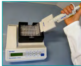
5. Immobilisierung (Binden des „Sandwichs“ an Affinitätsplatte, 10 min)
