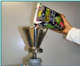
1. Probe filtrieren (250 – 1000 ml AfG, 15 min)
