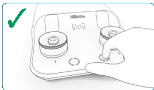
图 5:启动或停止泵的手指正确位置
