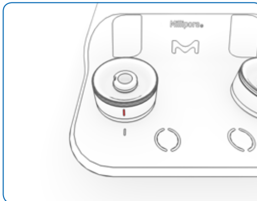
图 11:锁定的泵头上的标记与泵体上的标记对齐
