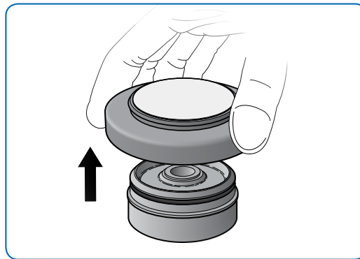
图 18: 拆卸过滤装置底座
