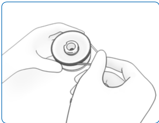
图 23:取下外部密封圈
