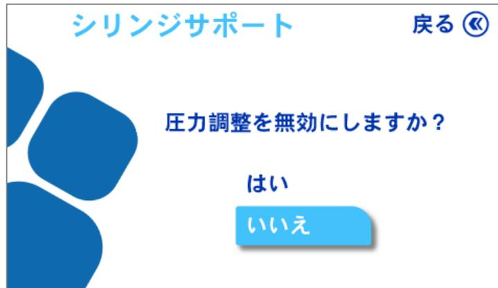
6. 「はい」を選択して圧力調整モードに切り替えます。
