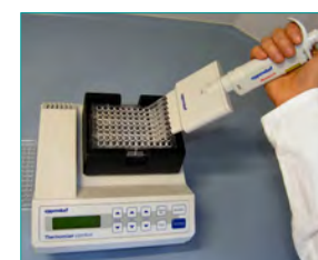
6. Waschen (Entfernen ungebundener Komponenten, 2x 1min)
