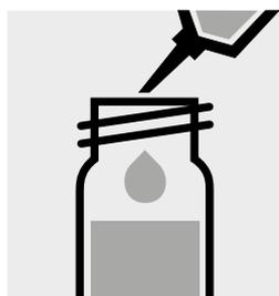
Pipetear 2,0 ml de la muestra en una cubeta de reacción, cerrar con la tapa rosca y mezclar.
