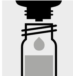
Añadir 4 gotas de pH-1, cerrar con la tapa rosca-da y mezclar. **Atención!** Para la dosificación mantener **verticalmente** el frasco de reactivo.
