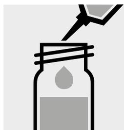
Pipetear 0,20 ml de la muestra en una cubeta de reacción, cerrar con la tapa roscada y mezclar.
