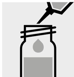
Pipetear 0,10 ml de la muestra en una cubeta de reacción, cerrar con la tapa roscada y mezclar.
