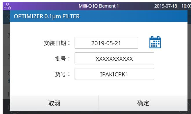
您可以手动输入数据, 也可以用e-Sure标签阅读器扫描RFID卡获取数据。
