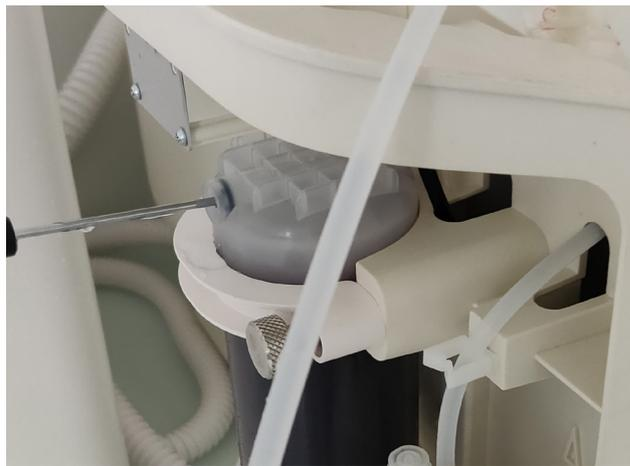
**重要提示:** 将螺丝刀的尖端插入 IPAK Quanta ICP® 滤芯的通风孔时要非常小心。通风孔只需要微微打开。
