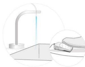
将Milli-Q IQ Element置于水槽附近, 然后踩脚踏踏板给系统泄压。
